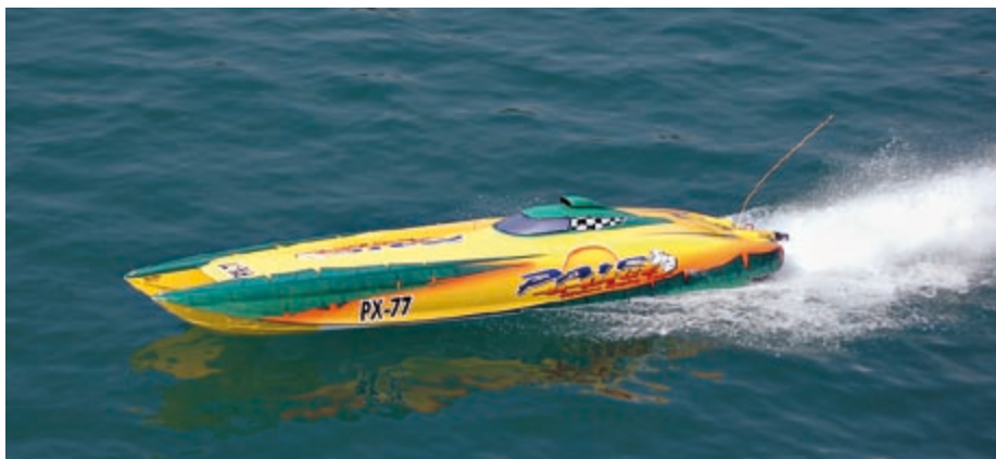
Die 2,33 m lange Pair-a-Dice von Jörg und Markus Marschall mit zwei Lehner 3080 und 12S8P Akku
