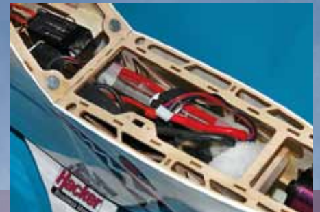
Für den Antriebsakku muss noch ein hinterer Anschlag eingebracht werden – gehalten wird der Akku mit einem Klettband.
