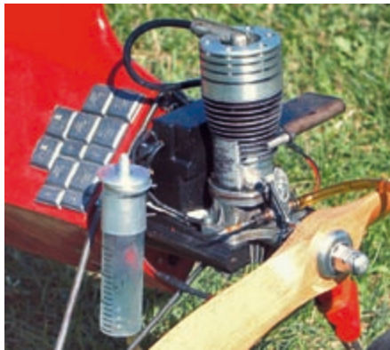
In der TEXACO Klasse sind alle Veränderungen am Motor zugelassen. Hier ein selbst gebauter Zylinderkopf auf einem amerikanischen Super Cyclone Motor (10 cm 3 )
