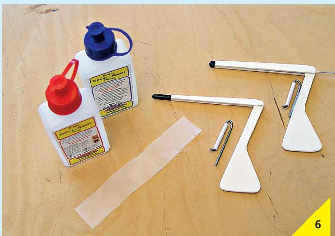
Das Ruderlager besteht aus einem Stückchen Bowdenzughülle (die Länge entspricht der Höhe des Heckspiegels) und 1,5-mm-Stahldraht, der so gebogen wird, dass sich das Ruder nicht aushängen kann. Fixieren Sie den Stahldraht mit etwas Klebstoff am Ruder und kleben Sie ihn dann mit Epoxydharz und einem Stoffstreifen fest.
