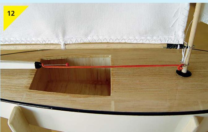
Befestigen Sie mit einer Stecknadel ein schwaches Gummiband an der Pinne und binden Sie das andere Ende mit geringer Spannung an den Niederhalter. Bewegen Sie jetzt mal den Großbaum leicht hin und her, um zu sehen, wie die Steuerung funktioniert.
