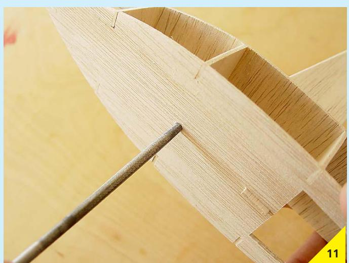
Fertigen Sie aus dem 4-mm-Buchenrundstab den 420 mm langen Mast an. Weiten Sie die Löcher in Deck und Boden ggf. mit einer Rundfeile vorsichtig auf und passen Sie den Mast ein. Er muss genau senkrecht auf dem Deck stehen. Kontrollieren Sie das von mehreren Seiten.
