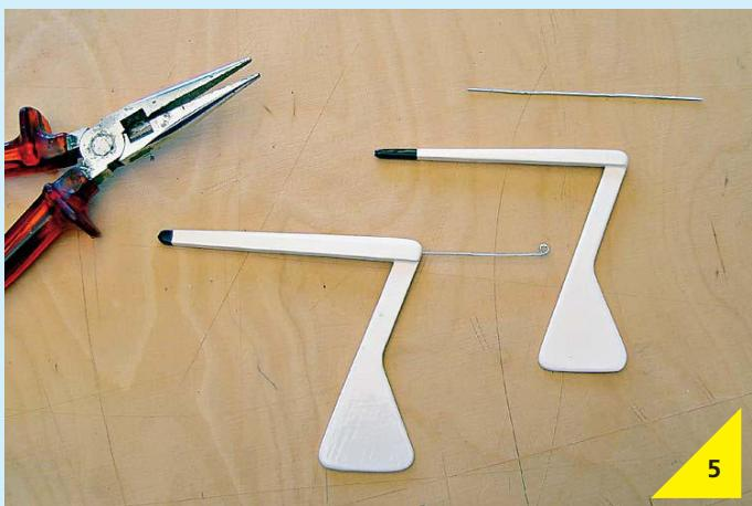
Aus einer weiteren Büroklammer fertigen Sie einen Draht mit einer Öse am Ende. Bohren Sie ein Loch von hinten in die Ruderpinne und kleben Sie den Stahldraht so ein, dass er ca. 45 mm nach hinten aus der Ruderpinne ragt.
