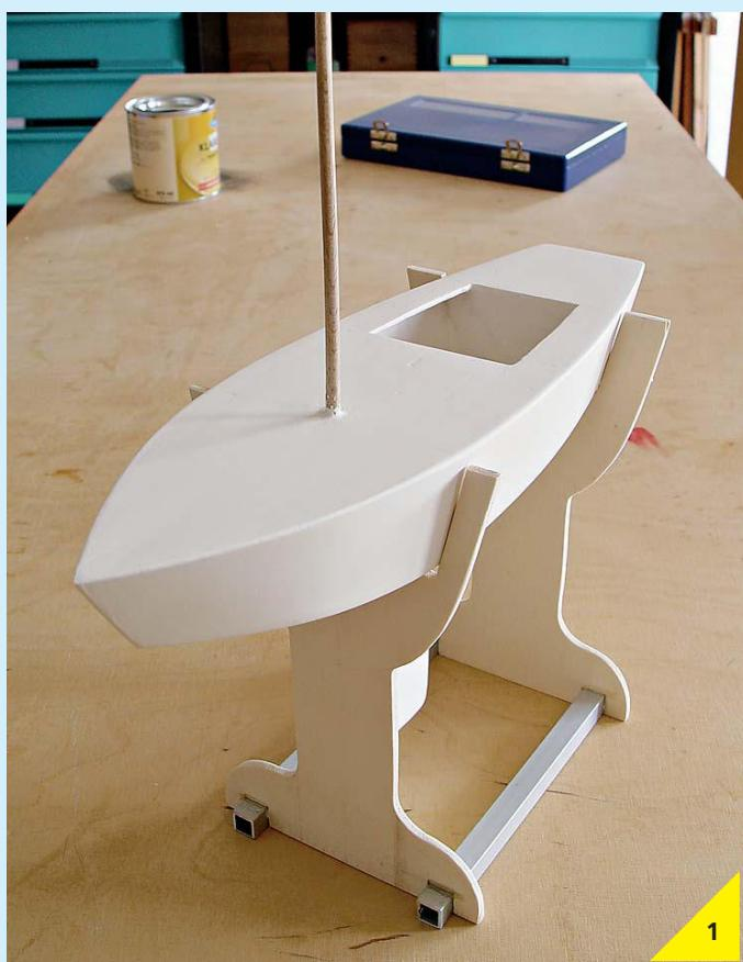
Eine gut füllende Vorstreichfarbe schließt die Poren des Holzes und ergibt einen guten Untergrund für die Schlussslackierung. Wer es genau nimmt, trägt nach vorsichtigem Zwischenschleifen eine zweite Schicht auf und bekommt damit eine spiegelglatte Oberfläche.
