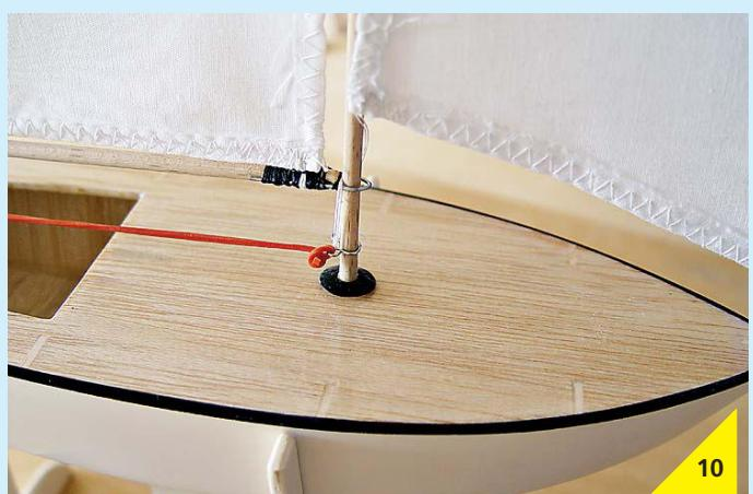
Biegen Sie aus Draht einen Niederhalter und befestigen Sie ihn unten am Mast. Hier wird das Focksegel mit etwas Spiel befestigt und der Großbaum gesichert. Das ist wichtig, damit er nicht nach oben gezogen wird, wenn Wind in das Segel fällt.
