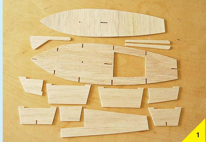
Wenn Sie alle Bauteile fertig ausgeschnitten haben, die auf dem Plan abgebildet sind, dann sieht das jetzt ungefähr so aus. Alle abgebildeten Teile sind aus mittelhartem 2-mm-Balsaholz. Glätten Sie die Kanten der Bauteile mit dem Schleifklotz, bevor Sie mit dem Bau beginnen.
