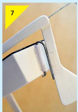
◀ Bohren Sie ca. 10 mm und 80 mm unterhalb der Mastspitze ein 1-mm-Loch, nähen Sie das Großsegel an den Großbaum, schieben Sie den Großbaum auf den Mast und binden Sie Fock- und Großsegel am Mast fest. Natürlich können Sie auch Beschläge aus Draht biegen und die Segel daran befestigen.
