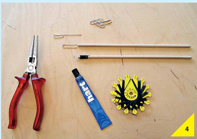
Fertigen Sie aus dem 4-mm-Buchenrundstab den 205 mm langen Großbaum an. Runden Sie die Enden mit Schleifpapier ab und befestigen Sie eine U-förmig aufgebogene und gekürzte Büroklammer mit Klebstoff und Zwirn an einem Ende. Der Metallbügel muss so groß sein, dass sich der Großbaum später frei am Mast drehen kann.
