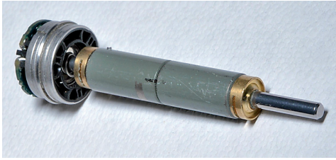
Bild 12: Innenläufer, Rotor mit Permanentmagneten.
