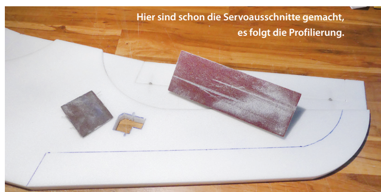
Das Unterteil ist auf dem Baubrett fixiert, mit Stecknadeln fixierte Anschläge erleichtern das Aufkleben des Oberteils.
