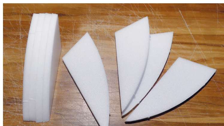
▲▼ Aus jeweils sechs Depronteilen werden die beiden Stützwimmer hergestellt. Sie erhalten eine Kielung und sollten nicht verrundet werden.
