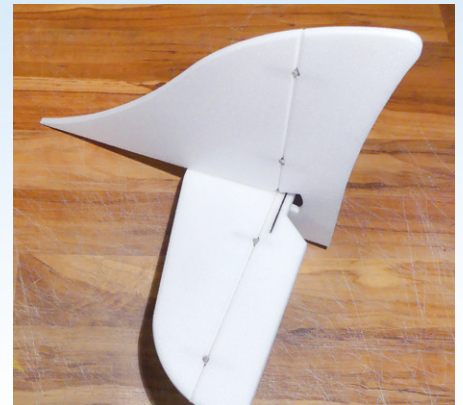
▲▼ Die Leitwerke sind den Flächen entsprechend angelenkt, das Höhenruderblatt bekommt mittig eine CFK-Verstärkung.
