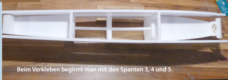
Und es sitzt auch perfekt, geklebt wird es mit UHU Por.
