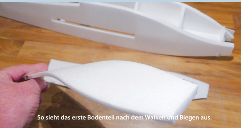
Und es sitzt auch perfekt, geklebt wird es mit UHU Por.
