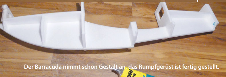
Beim Verkleben beginnt man mit den Spanten 3, 4 und 5.
