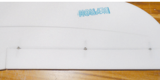
▼ Ein zusätzliches UHU-Por-Scharnier versteift das Ganze und macht die Ruder spaltfrei.
