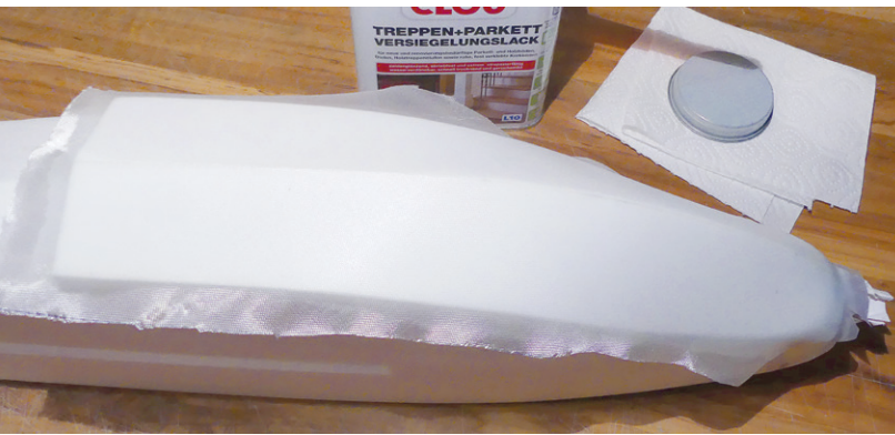
Schützt die Kielung: eine Lage 49-g/m 2 -Glasgewebe, mit Parkettlack aufgebracht.
