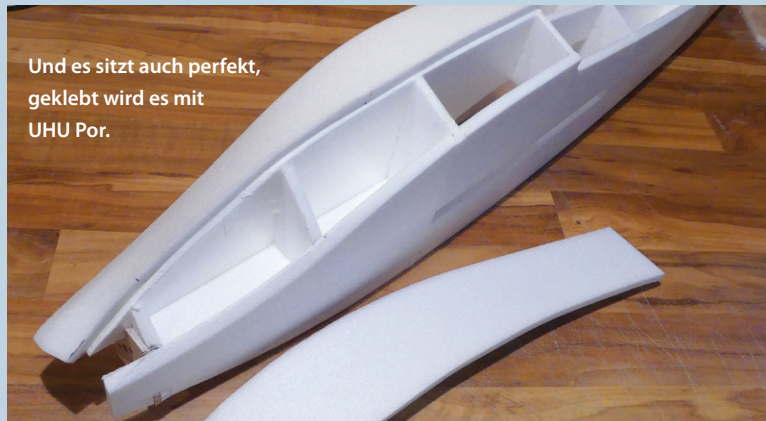
Beim Verkleben beginnt man mit den Spanten 3, 4 und 5.
