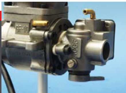
Der Kükervergaser: Der Anschluss oben am Vergaser ist der Kraftstoffzufluss, der Anschluss am Zylinder führt in den Überströmkanal und dient dem Antrieb der separaten Kraftstoffpumpe.
