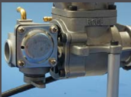
Unter dem Deckel mit der Bohrung sitzt die Membran des Kraftstoffdruckreglers.
