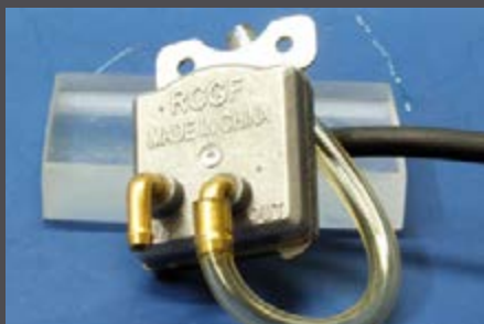
Die Kraftstoff-Förderpumpe: In und Out bezieht sich auf den Kraftstoff, der schwarze Schlauch an der Rückseite ist der Pumpenantrieb und führt zum Anschluss am Überströmkanal.
