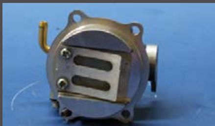
Die Einlass-Steuerung erfolgt per Flatterventil.
