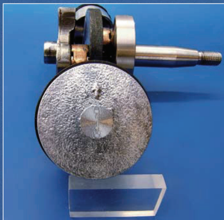
Die Pfeile auf dem Kolbenboden zeigen immer zum Auspuff.
