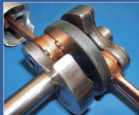
Detailaufnahme der dreiwangigen Kurbelwelle
