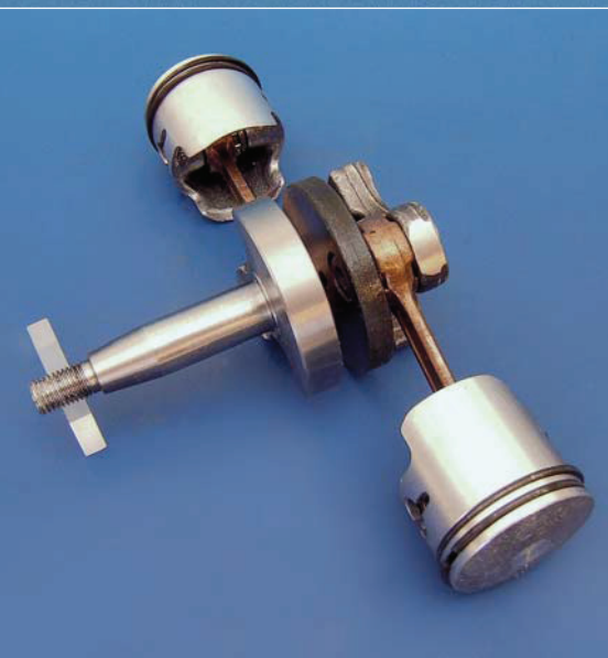
Die Kolben tragen zwei Kolbenringe mit Verdrehsicherung.
