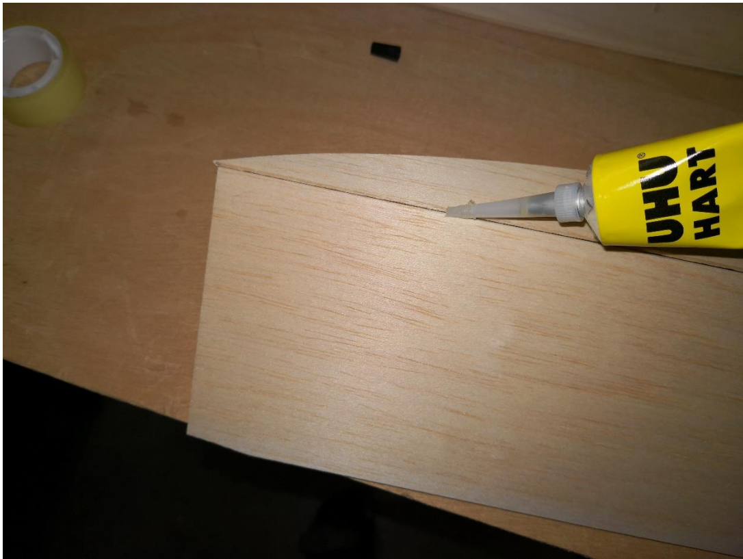
45: Nahtstelle aufklappen und mit Uhu hart verkleben.
