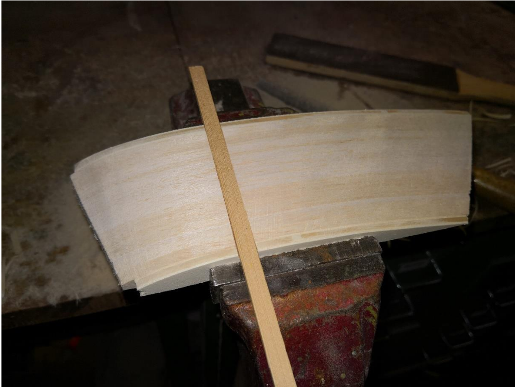
11: Mit dem Puk den Holmausschnitt einsägen und herausbrechen. Die Feinarbeit geschieht mit der Feile oder einer Kiefernleiste mit aufgeklebtem Schleifleinen. Die Originalleiste zur Kontrolle heranziehen.
