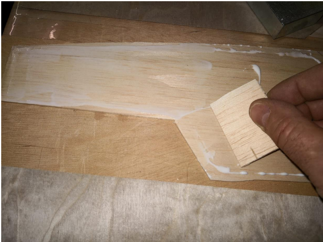
46: Sperrholzverstärkung 0.4 mm grob zuschneiden und Innenseite flächig mit Kaltleim einstreichen.
