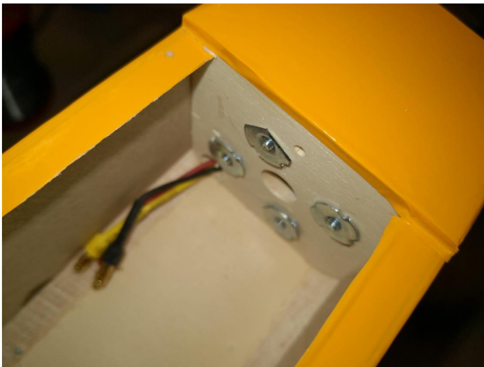
114: Mit M3-Einziehmuttern den Motor verschrauben. Motorkabe durchführen. Anschließend noch Eckleimer (73) einkleben.
