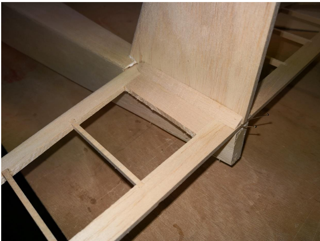
94: Leitwerk verkleben und fixieren. Später unten mit weiteren Dreikantleisten verstärken. Anschließend alle Bauteile verschleifen und zum Bügeln vorbereiten.
