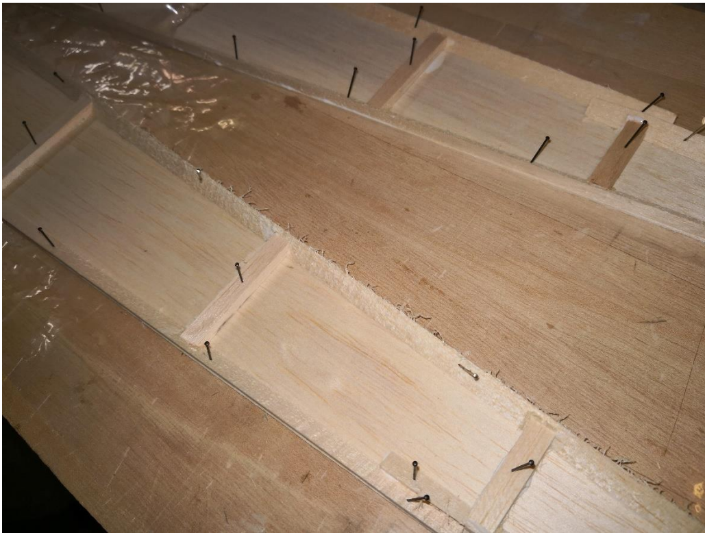
54: Um ein Springen des dünnen Balsas in Längsrichtung zu verhindern werden im Heckbereich Aussteifungen (41) eingeklebt.
