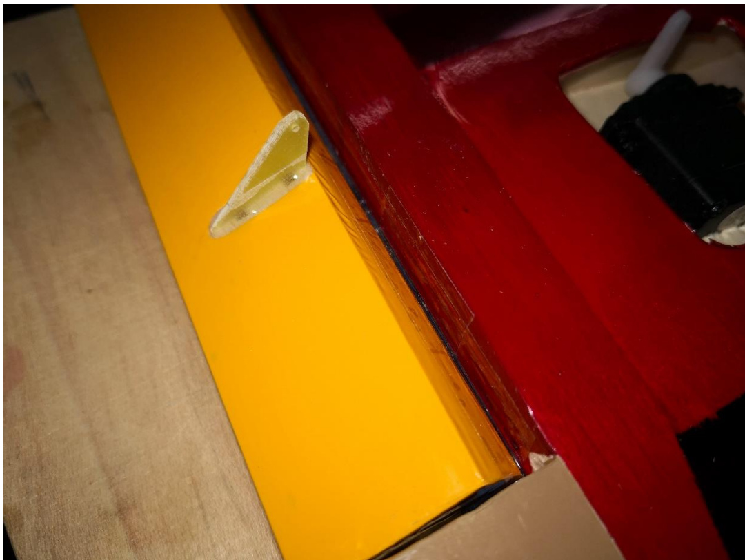
104: Folie partiell entfernen und mit dicker Raupe aus 5-min-Epoxi verkleben.
