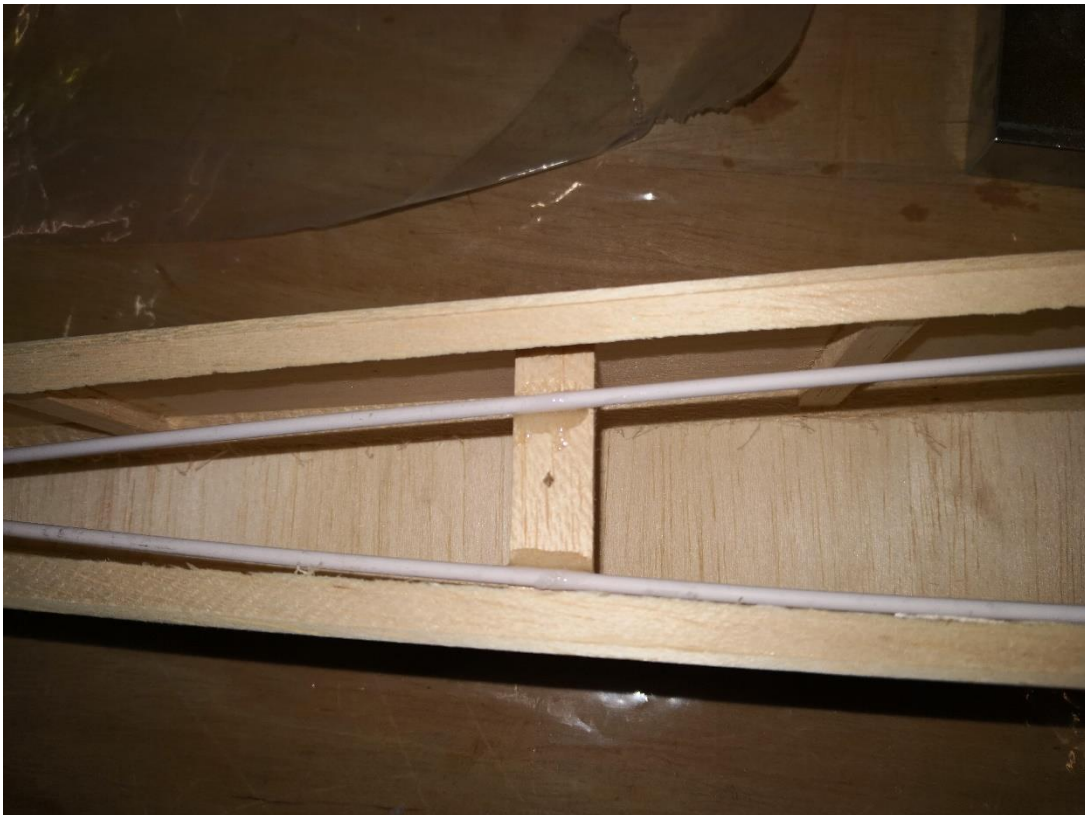
63: Für die Abstützung der Bowdenzüge im Heckbereich eine Auflage (44) einsetzen. Die Bowdenzüge an der späteren Verklebestellen großzügig anschleifen und hinten und in der Mitte mit 5-min-Epoxi verkleben.
