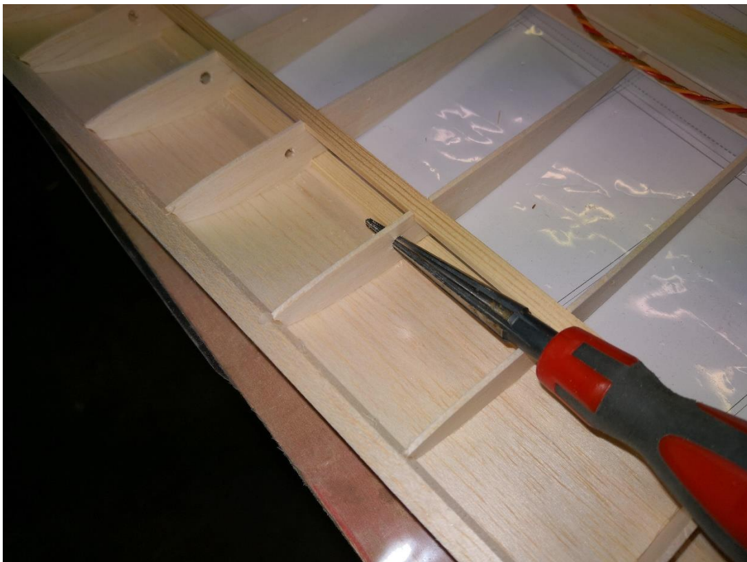
24: Mit dem Sticher Bohrungen für das QR-Kabel setzen.
