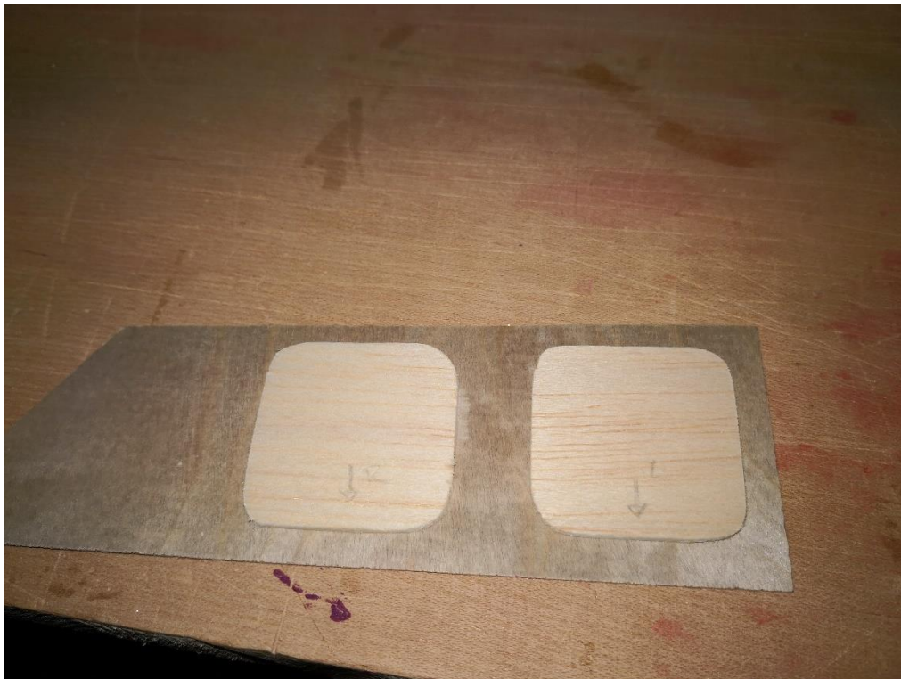
106: Abdeckungen für die QR-Servos vorbereiten (B1.5, Sp0.4)
