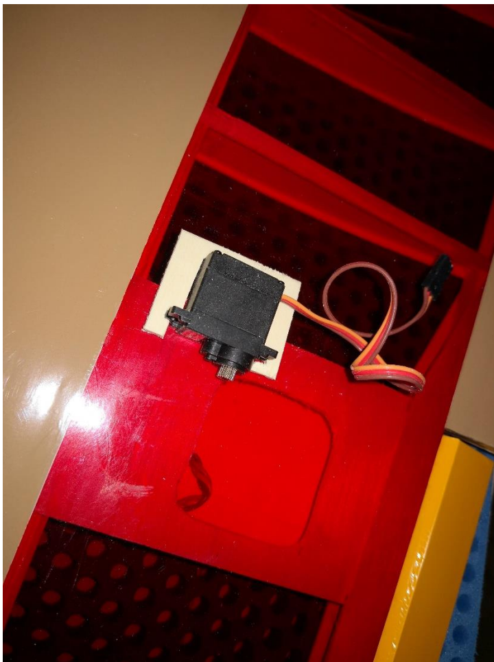
98: Rahmen dient dem formschlüssigen Einbau und dem Aufdicken des Servobretts.
