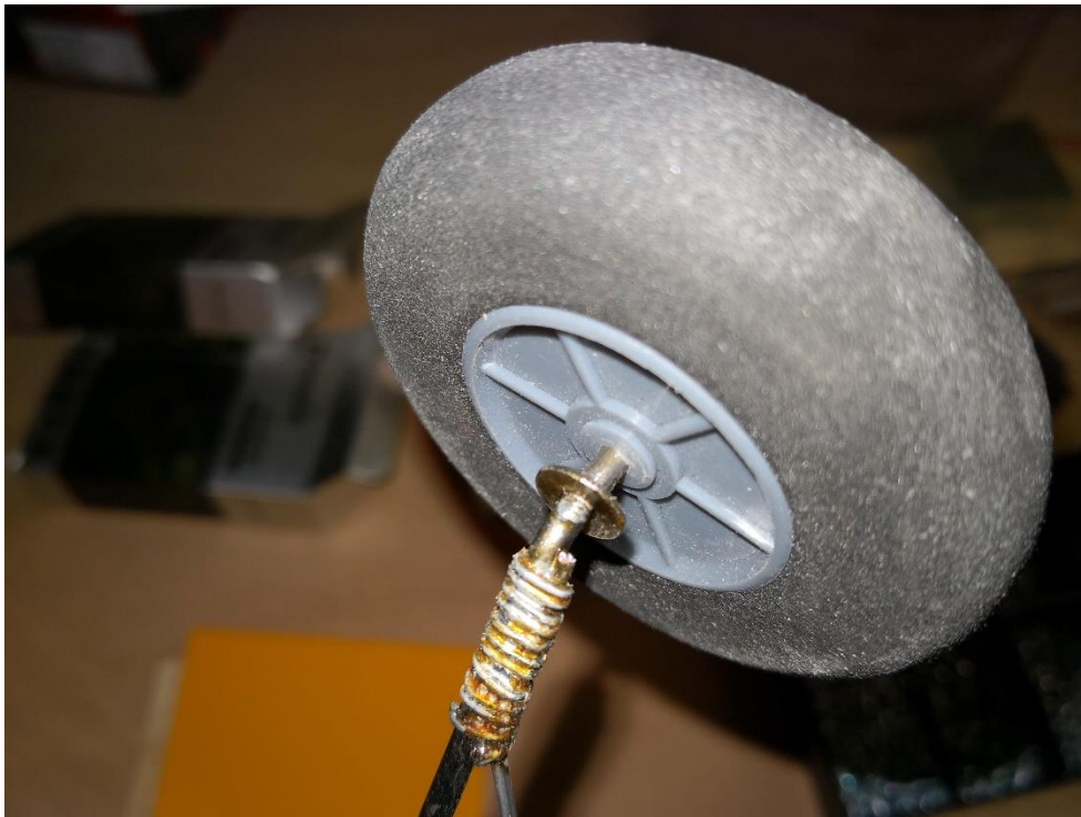
111: Die Räder mit Beilagscheibe gegen Klemmen am Radius des Drahtes schützen. Auf der Außenseite mit Stelling sichern.
