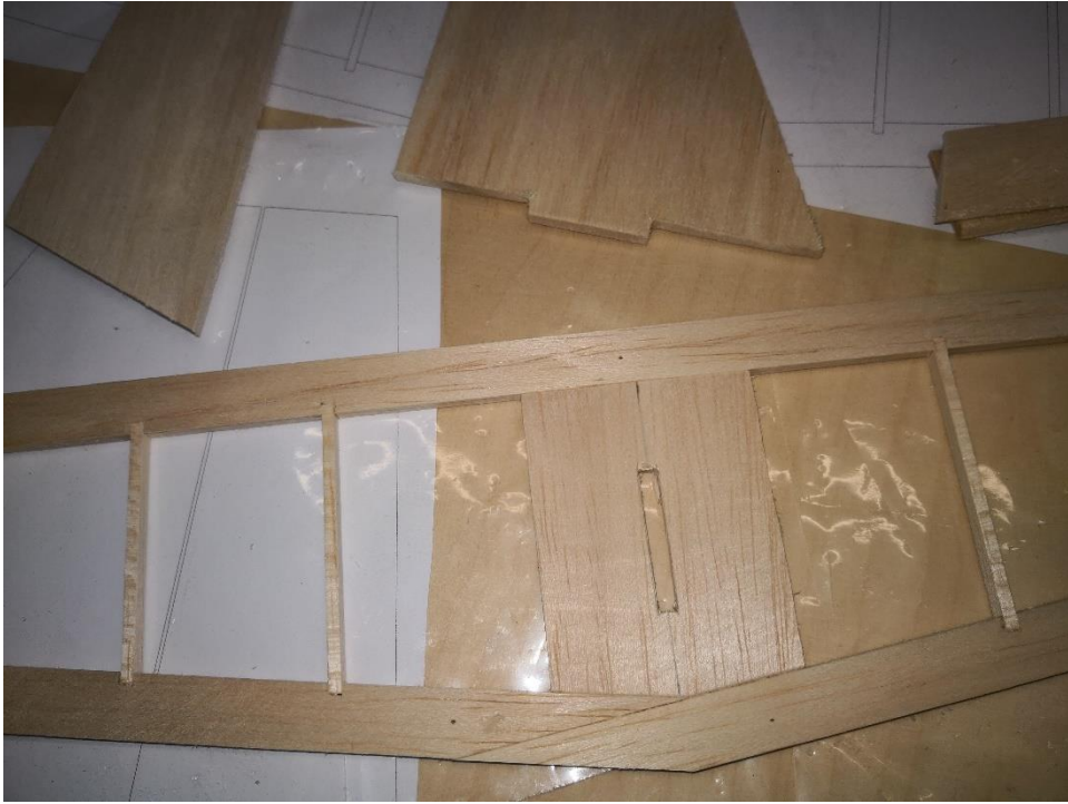
89: Die Leitwerksteile vor dem Verkleben verschleifen.
