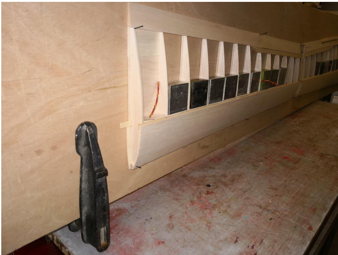
34: Beim Verkleben der Stege muss der Flügel flach aufgenagelt werden, um ein verzugsfreies Ergebnis zu erhalten. Mit zwei Schraubzwingen kann dabei das Baubrett hochkant gestellt werden. Damit kann das Anpressen der Stege mit kleinen Gewichten erfolgen. Den Flügel gut festnageln!
