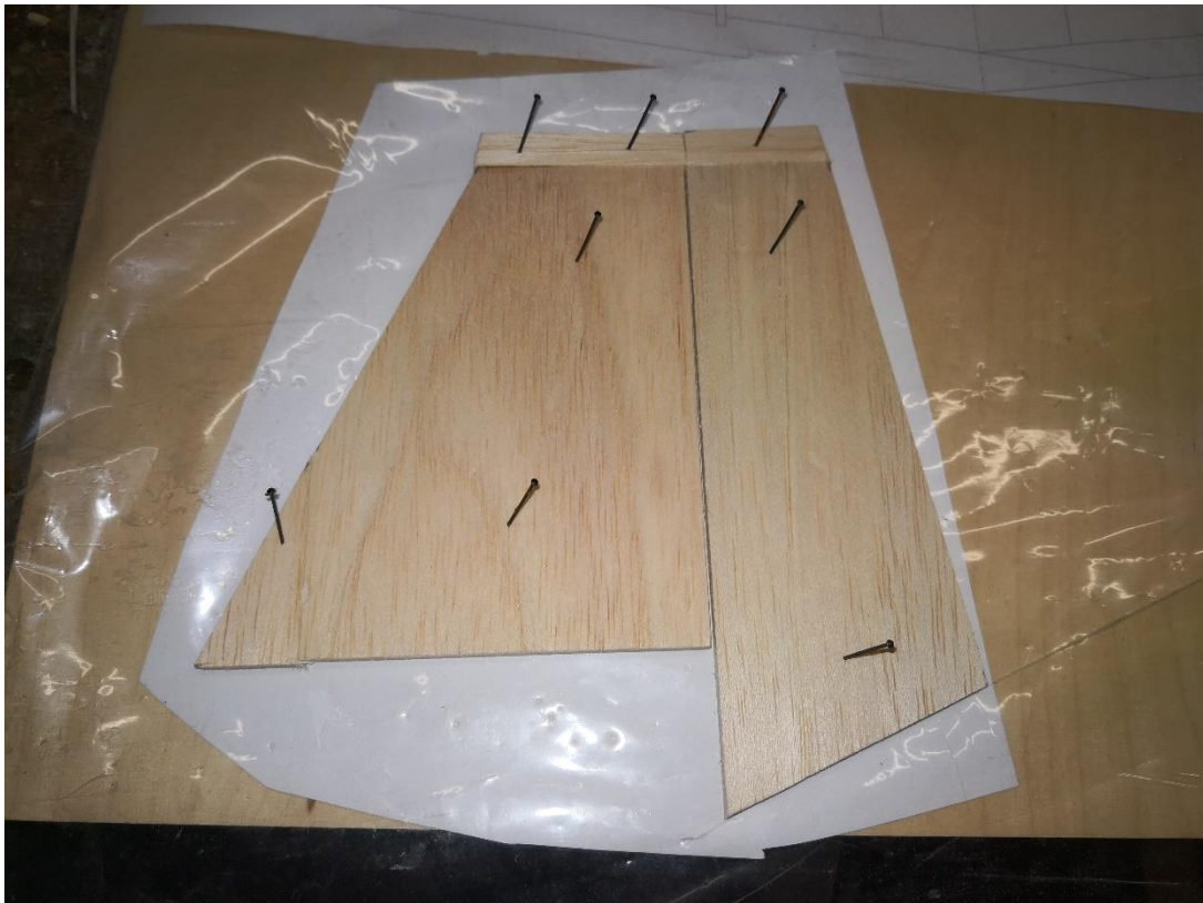
88: Um Verzug zu vermeiden wird ein schmaler Streifen oben längs verklebt.
