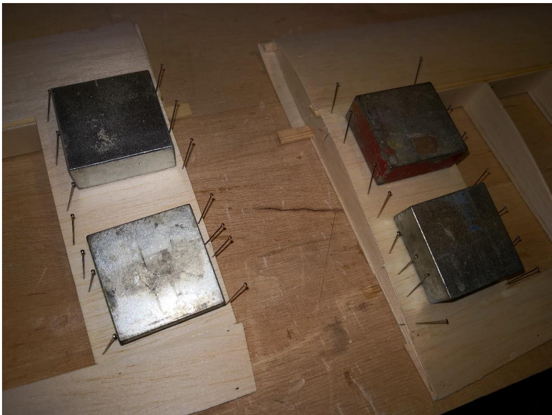
36: Beplankung mit Nadeln anstecken und zusätzlich mit Gewichten anpressen.
