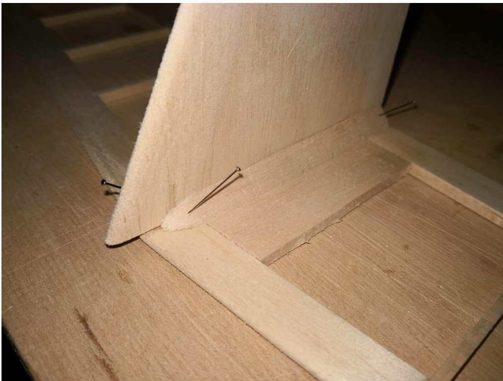
92: Die Ecke mit einer Dreikantleiste aussteifen. Vorne anschleifen.
