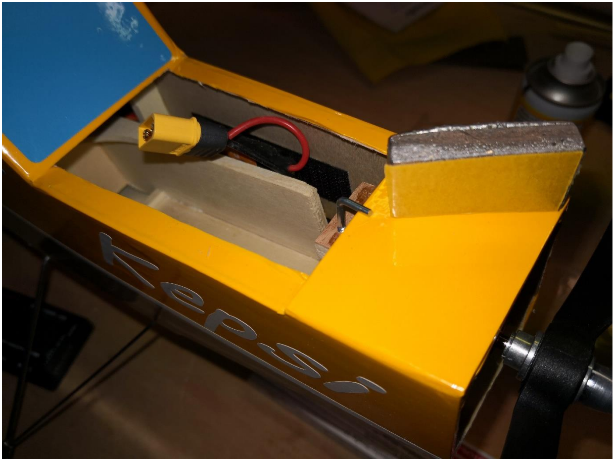
120: Das Blei wird ganz vorne am Rumpfboden mit Doppelklebeband fixiert.
