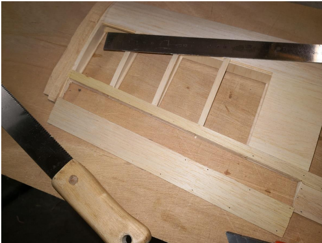
41: Mit Lineal, Klinge und Japansäge werden die QR ausgeschnitten. Anschließend grob verschleifen.
