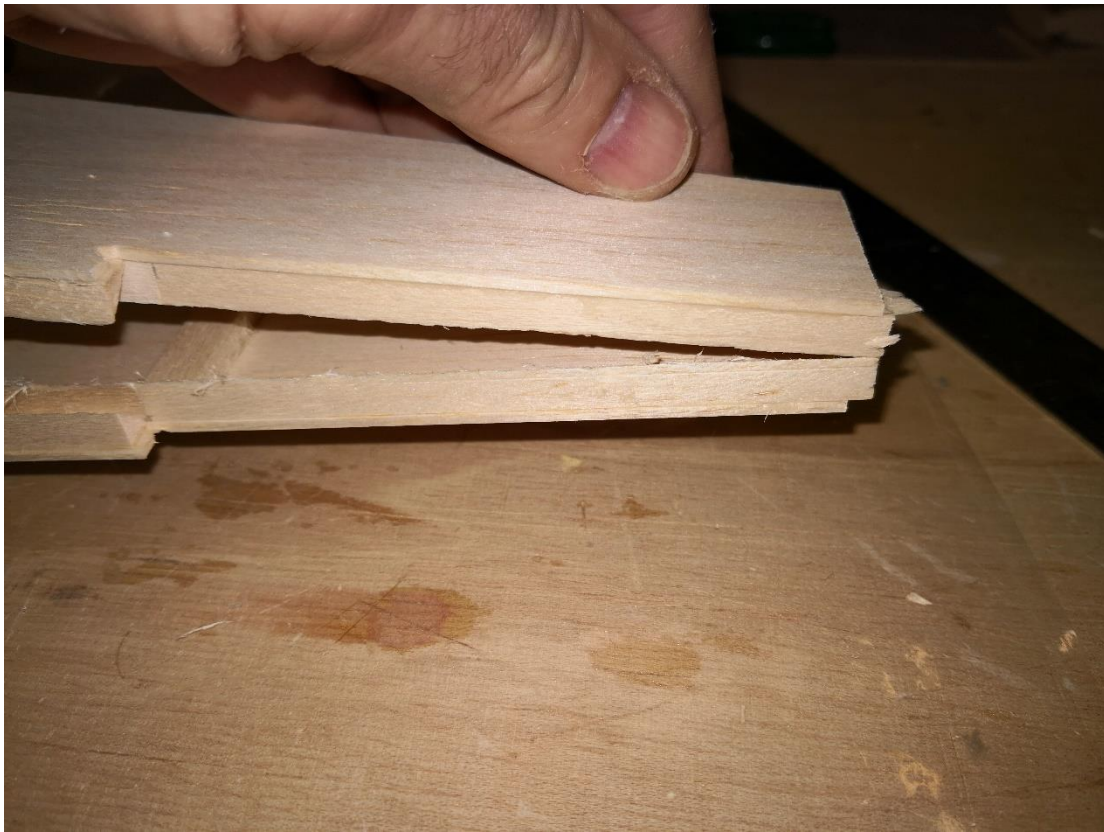
56: Auch am Heck muss eine saubere Überdeckung vorliegen.
