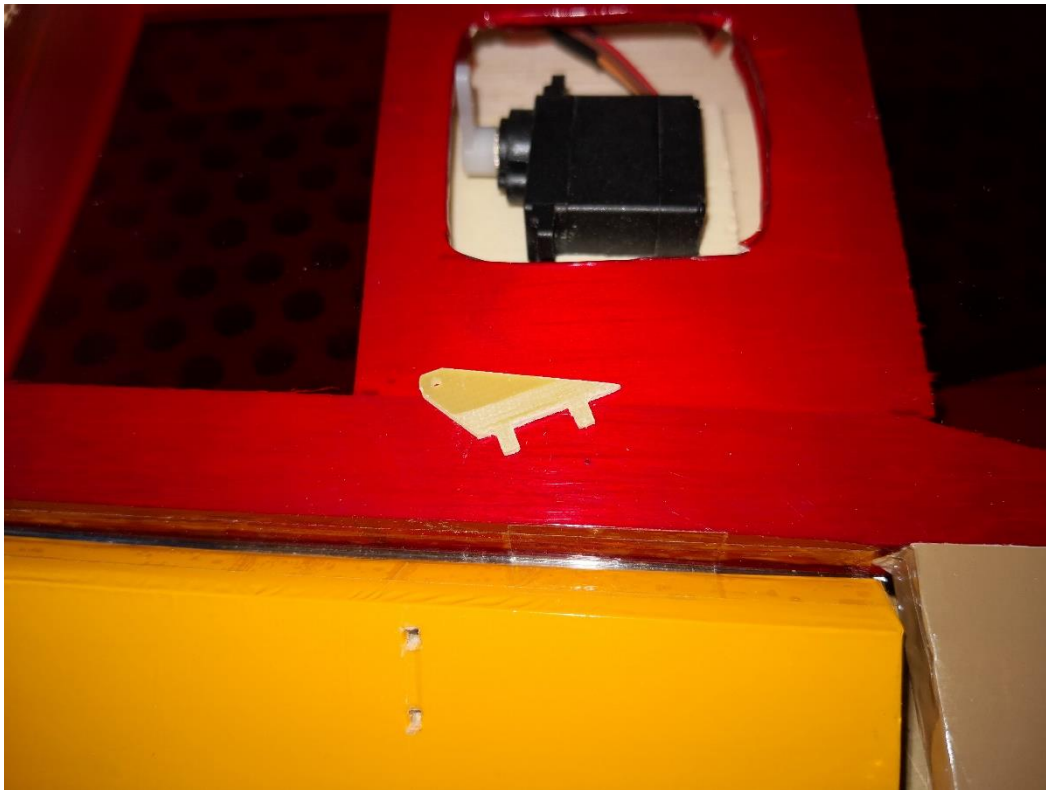
103: Ruderhorn anschleifen und Steckung vorbereiten.
