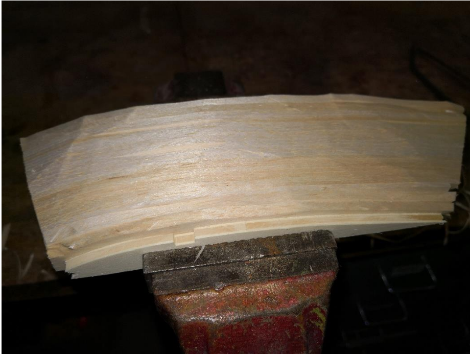
9: Mit dem Cutter grob zurecht schnitzen. Vorsicht Verletzungsgefahr!
