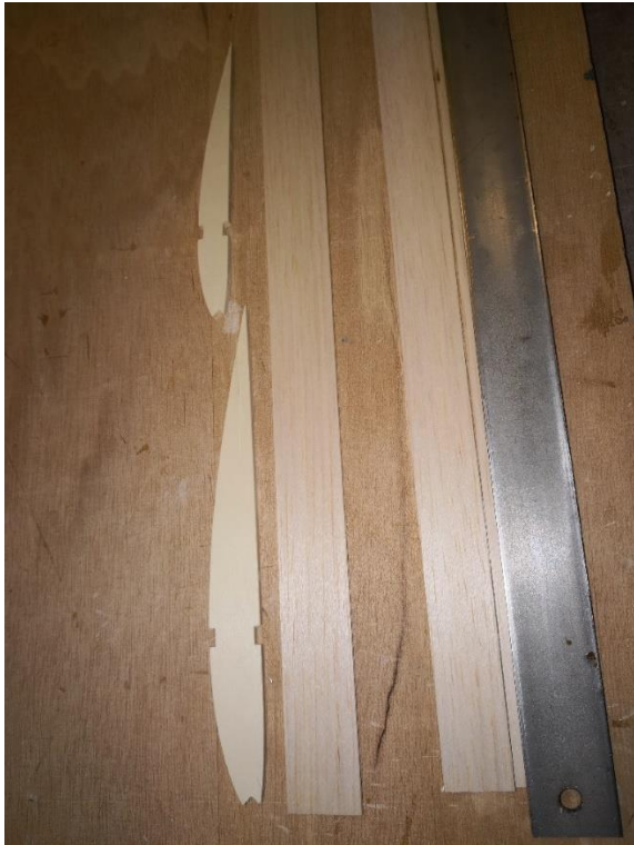
1: Zuschneiden von schmalen Streifen aus 2 mm Balsa
