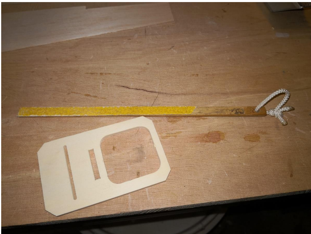
49: Spanten aus Frästeilesatz brechen und verputzen.
