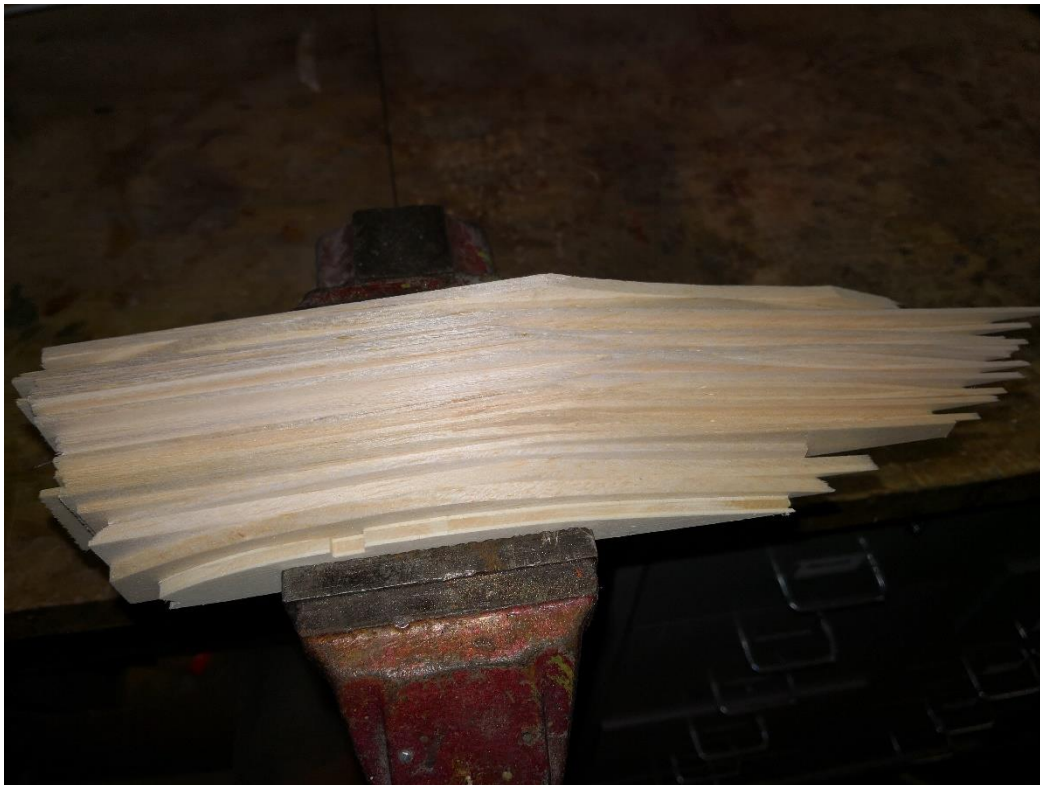
7: Der rohe Rippenblock wird vorsichtig im Schraubstock gespannt. Vorher alle Rippen-Rohlinge auf dem Tisch nach unten drücken. Die beiden Musterrippen etwas vom Tisch anheben. Darauf achten, dass die Holmausschnitte möglichst rechtwinklig fluchten.
