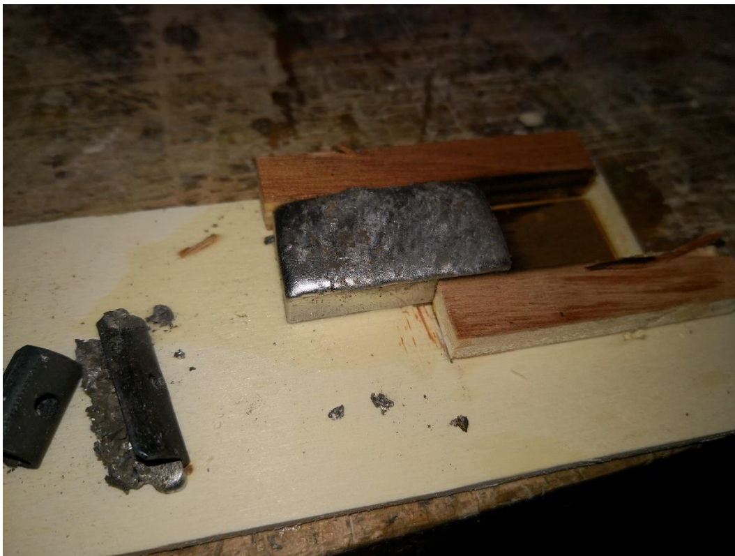
119: Nach dem Entformen. Links die ausgeschmolzenen Stahlklammern
