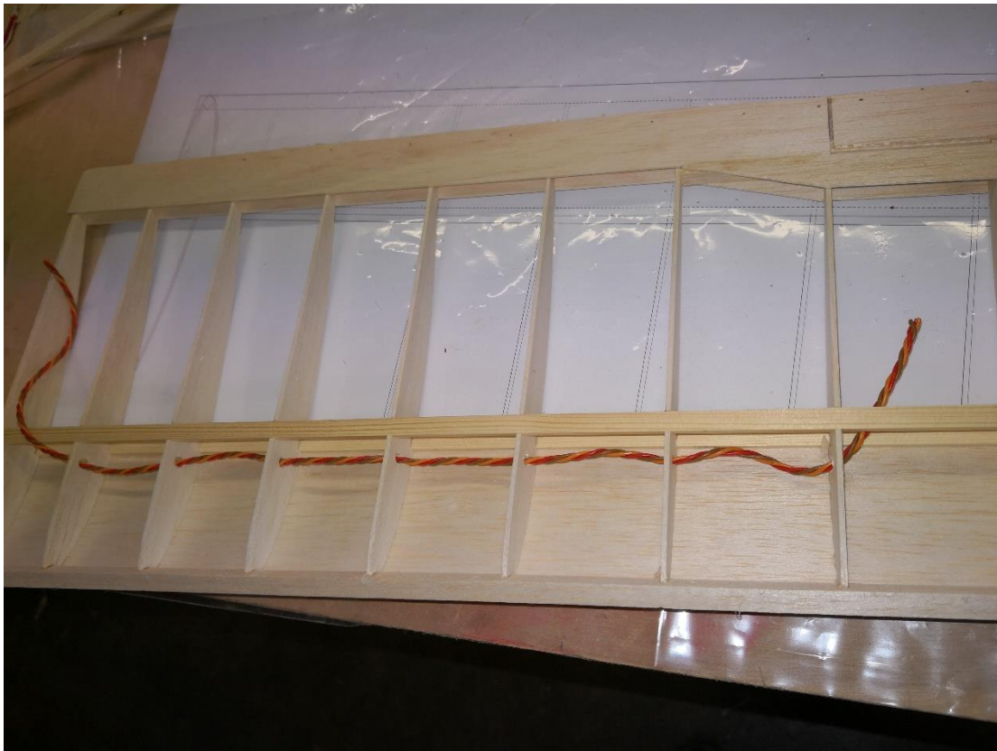
25: QR-Kabel verlegen, ausreichend Überstand vorsehen.
