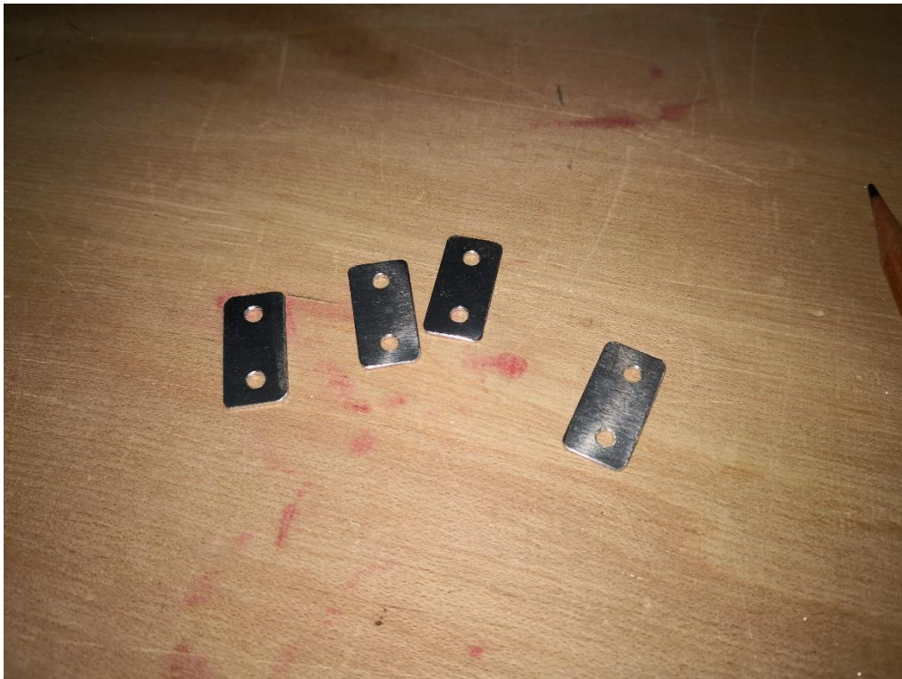
75: Blechen bohren, entgraten, auf Form schneiden mit der Blechschere und verputzen.
