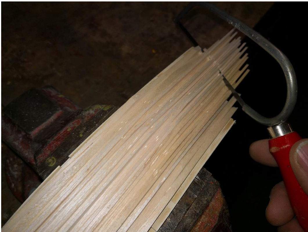
8: Vorne und hinten können mit dem Puk bereits die groben Überstände abgesägt werden.
