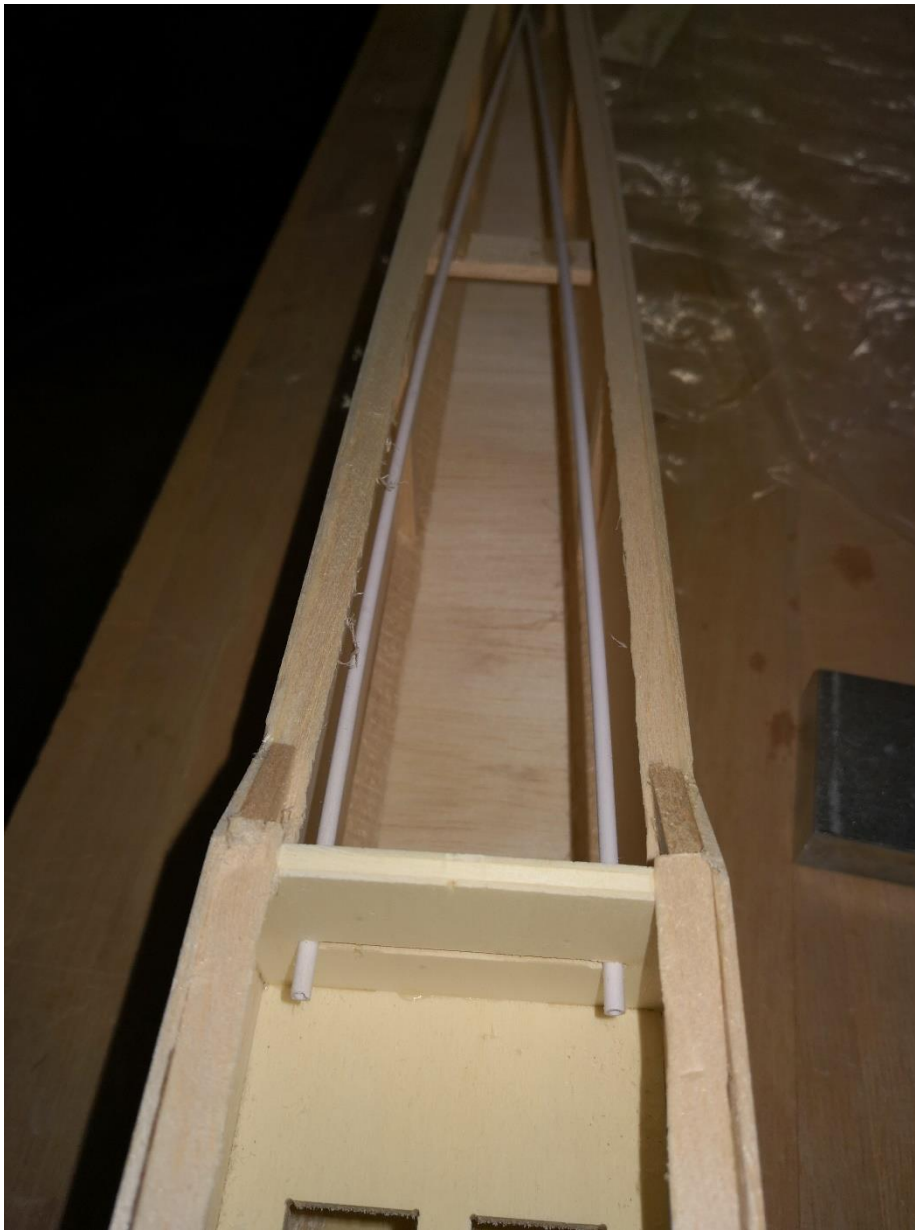
64: Um möglichste große Radian zu erhalten kreuzen die Bowdenzüge. Vorne werden sie vorerst nur im Langloch gehalten und erst am Ende verklebt.
