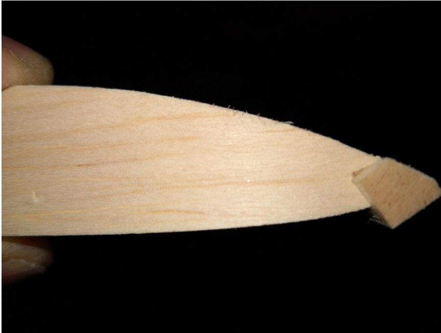
19: Nasenleiste plan schleifen, tangential an die Rippenkontur. Damit lässt sich die Beplankung gut verkleben.
