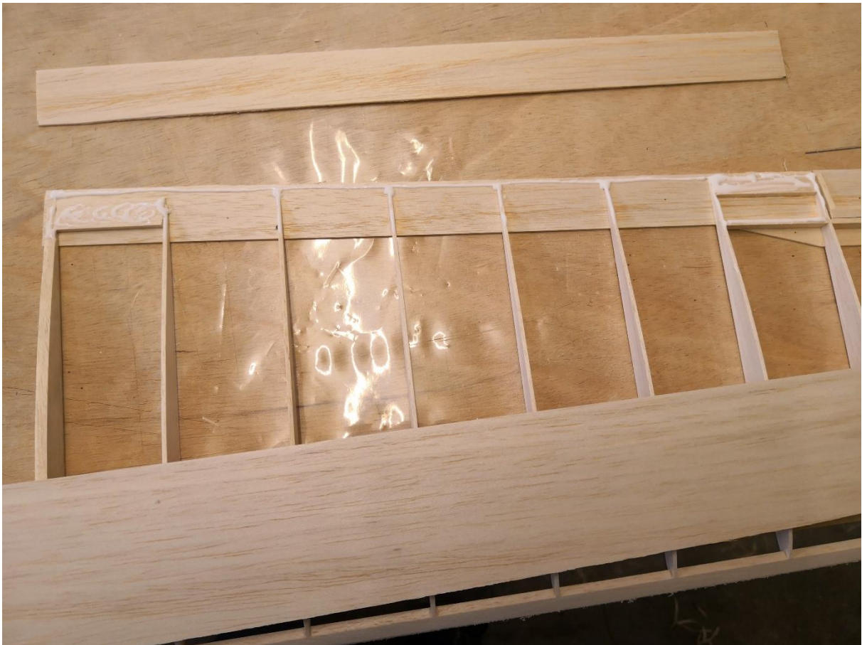
20: Beplankungsteile zuschneiden und Leim aufbringen.
