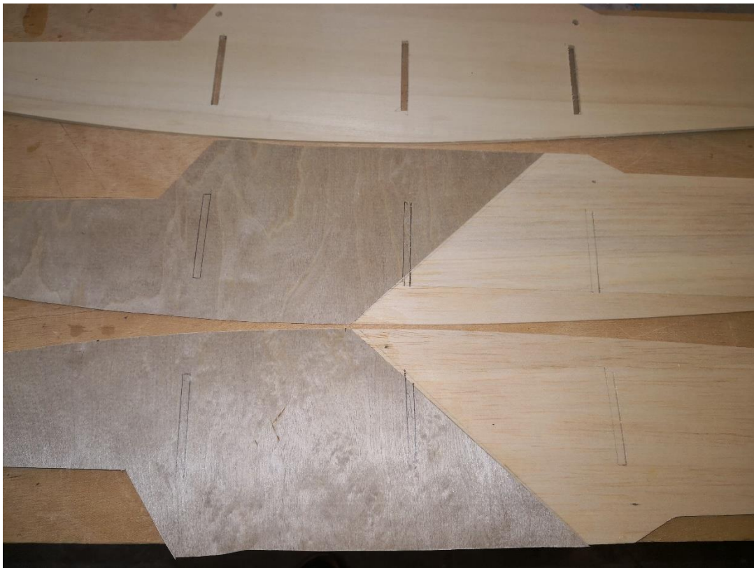
51: Von Plan oder Schablone die Lage der Spanten und die Bohrungen für die Dübel anzeichnen.
