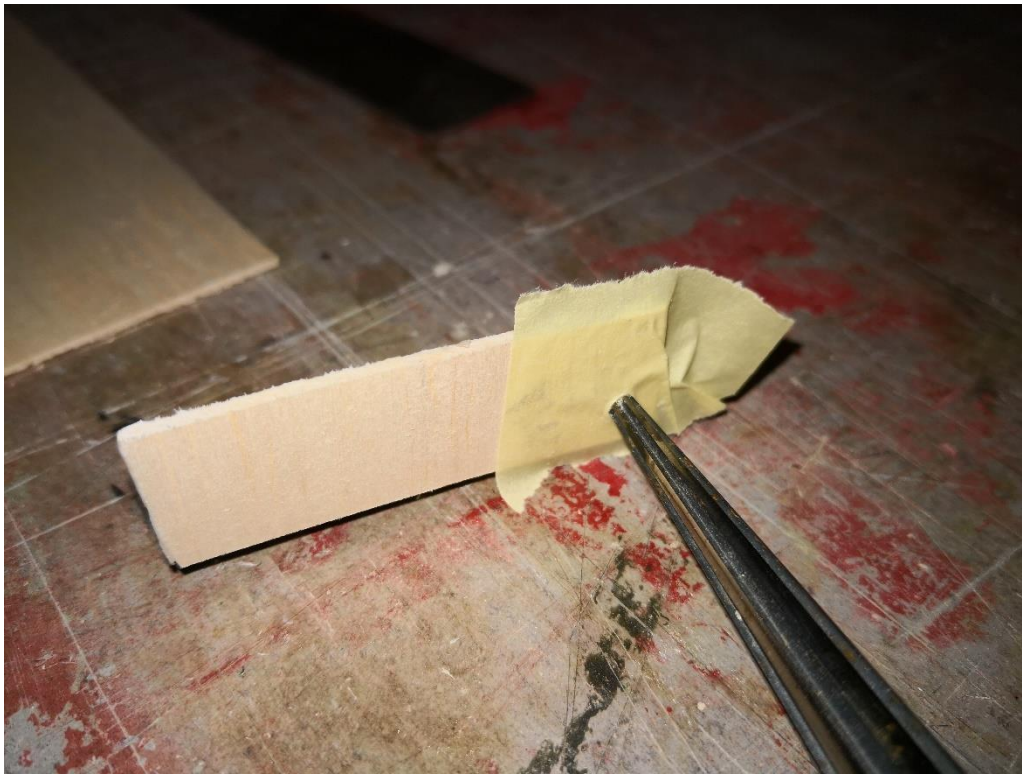
33: Beim Setzen der Bohrungen für die QR-Kabel verhindert etwas Klebeband das Springen des dünnen Balsa.
