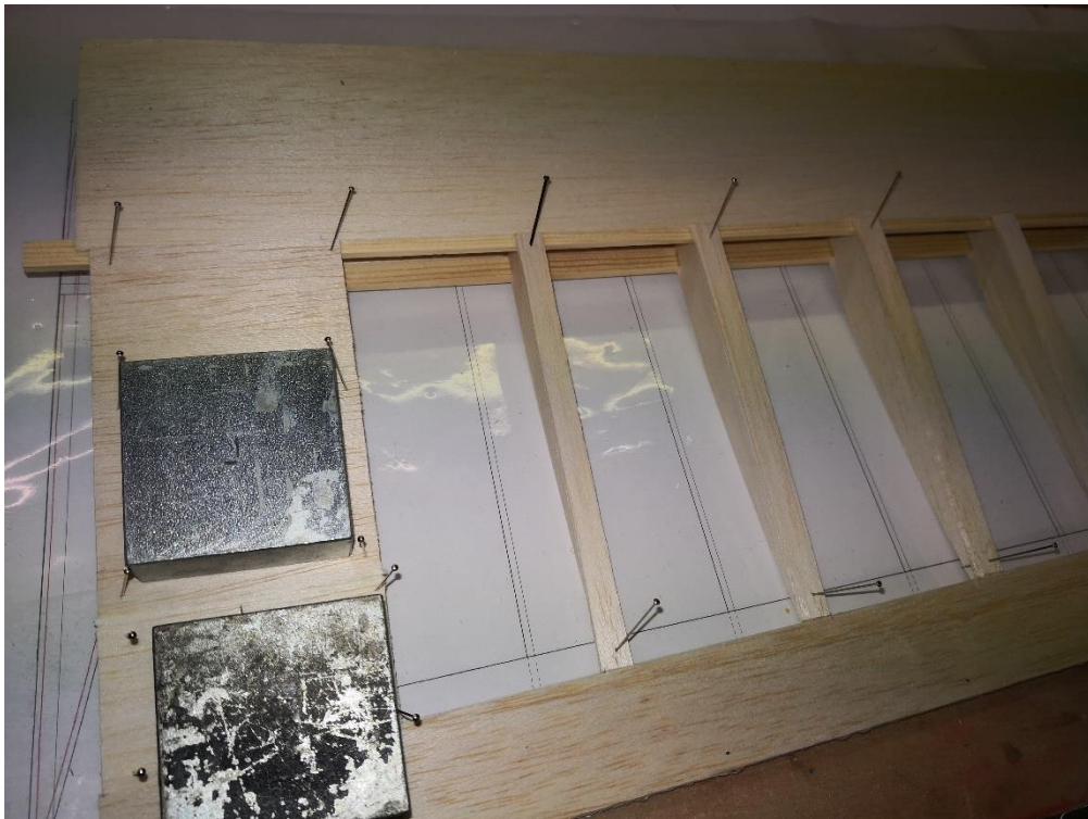
27: Auf der Unterseite die Beplankungsteile (16) und die Aufleimer (20) fertigen.
