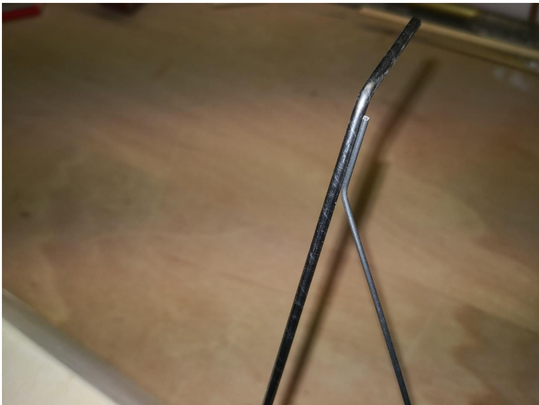
78: Je besser die Drähte fluchten, desto leichter fällt das Umwickeln und verlöten.
