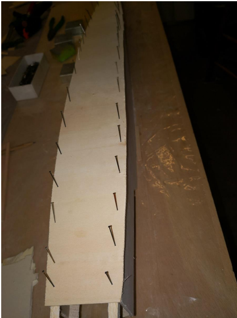
60: Der Rumpfboden (Sp 3 mm quer) wird mit Nadeln fixiert. und angepresst.
