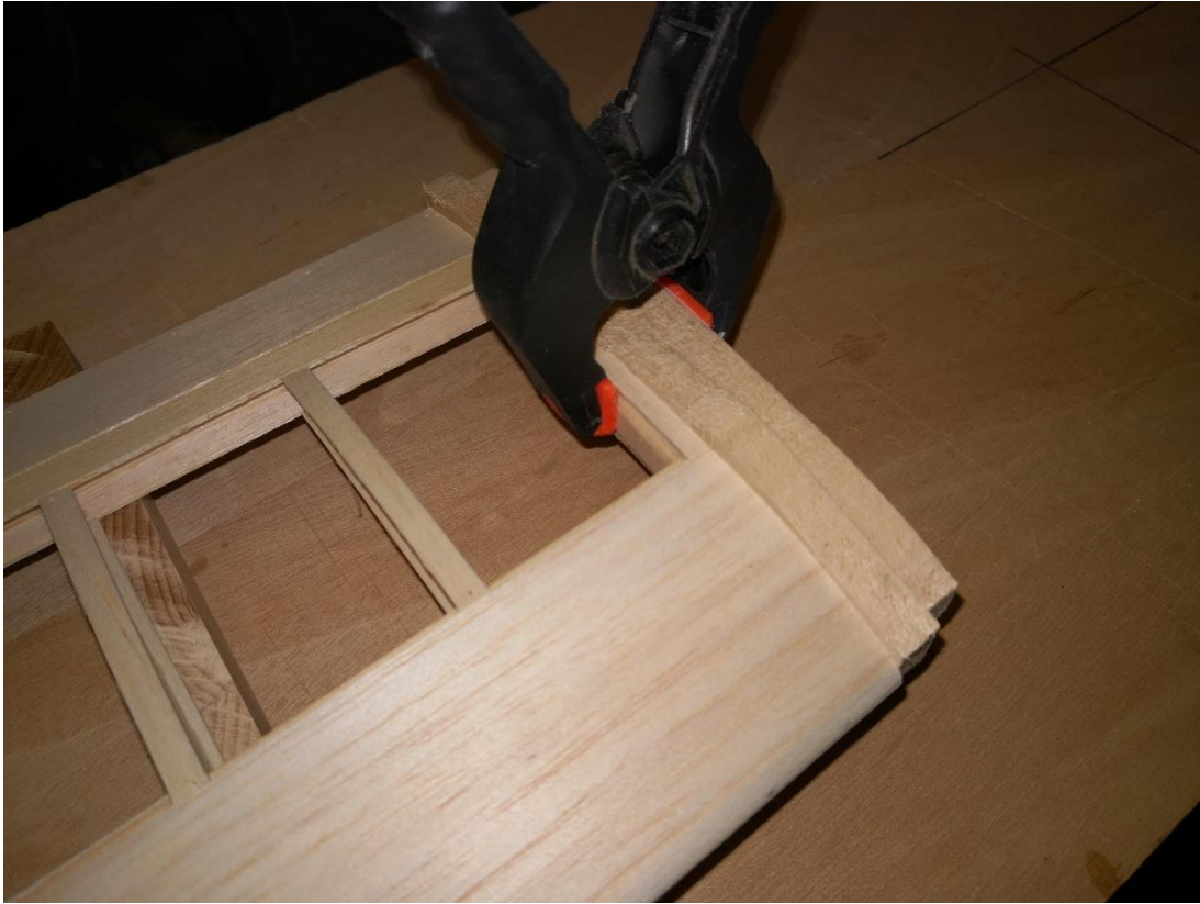
39: Anbringen der Randbögen. Ein kleines Reststück Balsa innen auf der Rippe verhindert eine Beschädigung des Aufleimers.
