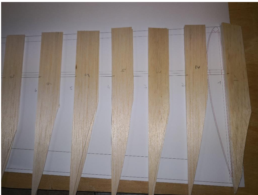
4: Die Rippen-Rohlinge werden nummeriert und eine Markierung an der hinteren Holmkante angebracht
