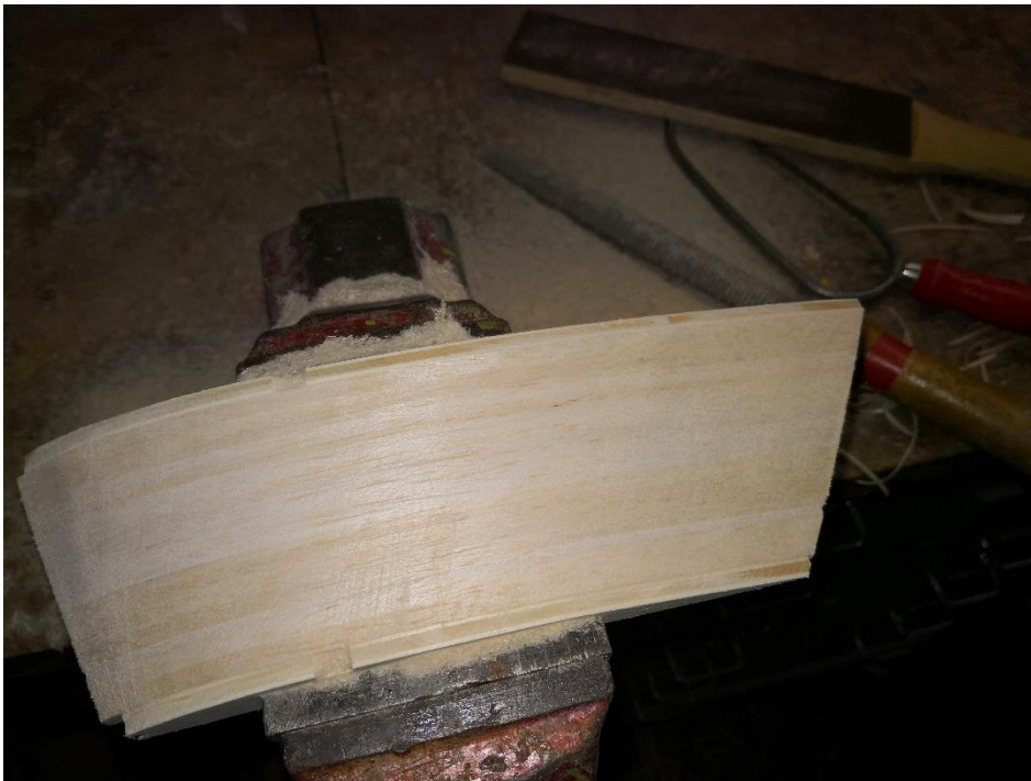
10: Den Rippenblock mit Raspel und Schleifklotz gleichmäßig bearbeiten. Das Werkzeug dabei immer an die Schräge anpassen (hinten nach rechts schwenken, vorne nach links schwenken). Darauf achten, dass eine Gerade die Innen- und Außenrippe verbindet. Das Werkzeug muss plan aufliegen! Nur dann werden die Rippen gleichmäßig kleiner.
