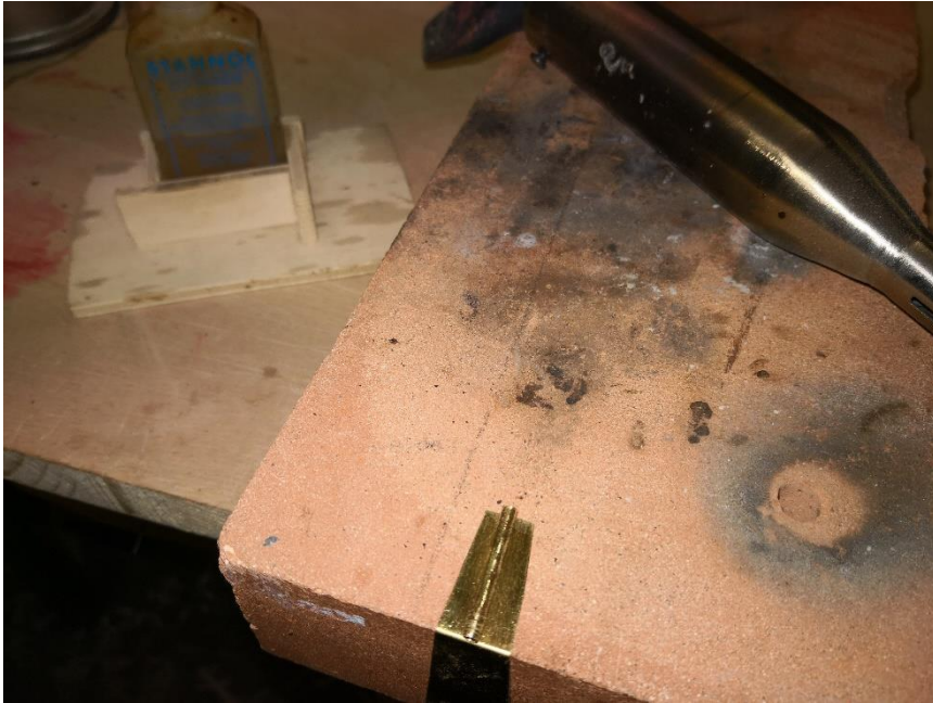
83: Für das Spornrad das Messingblech zuschneiden, abwinkeln und das MS-Rohr auflöten.
