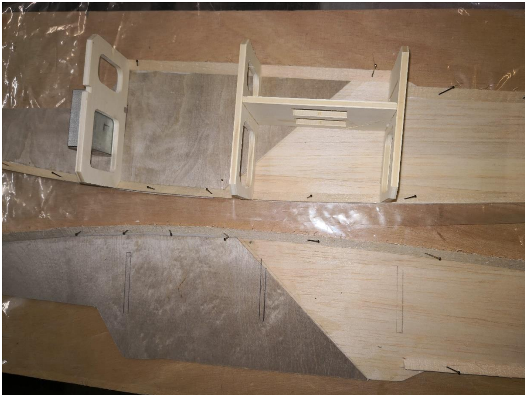
53: Die Dreikantleisten werden aufgenagelt (Tisch mit Folie schützen). Die korrekten Abstände werden mit den Spanten kontrolliert.
