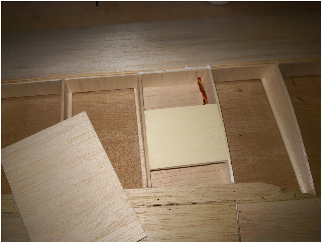
35: Einbau des Servobretts, bevor die Beplankungsteile und die Aufleimer verklebt werden.
