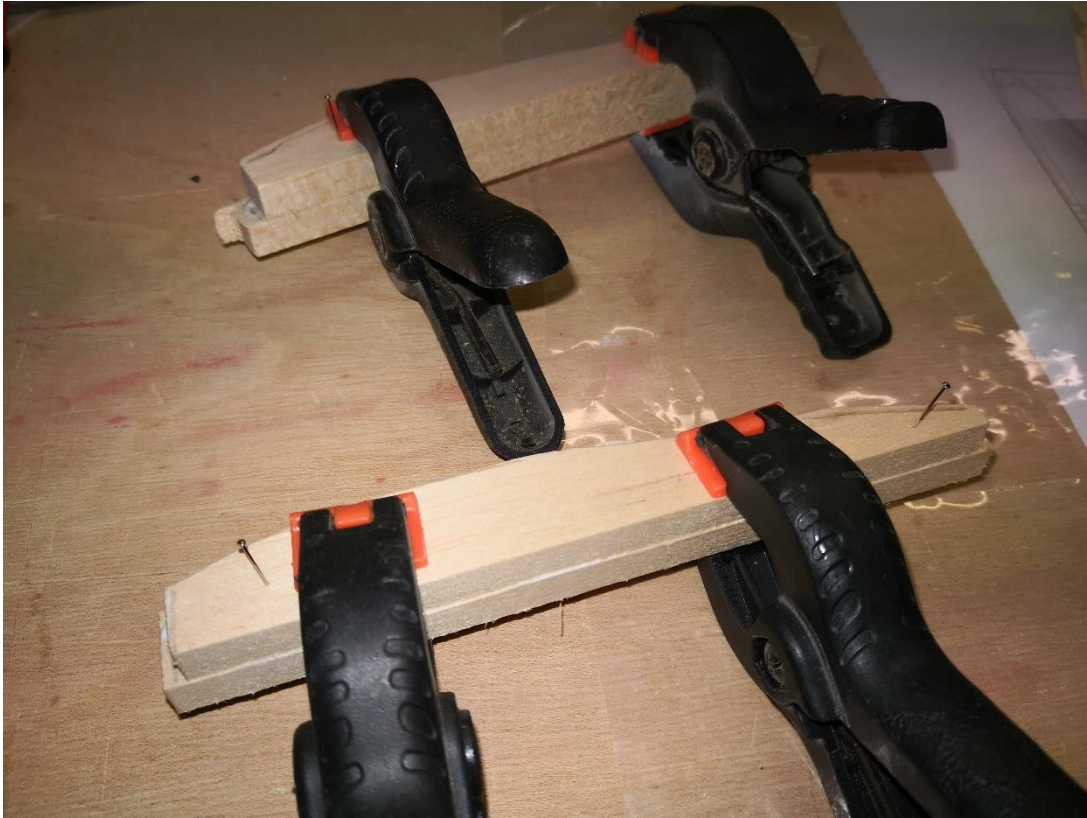
31: Mit Nadeln fixieren und mit Klammern pressen.
