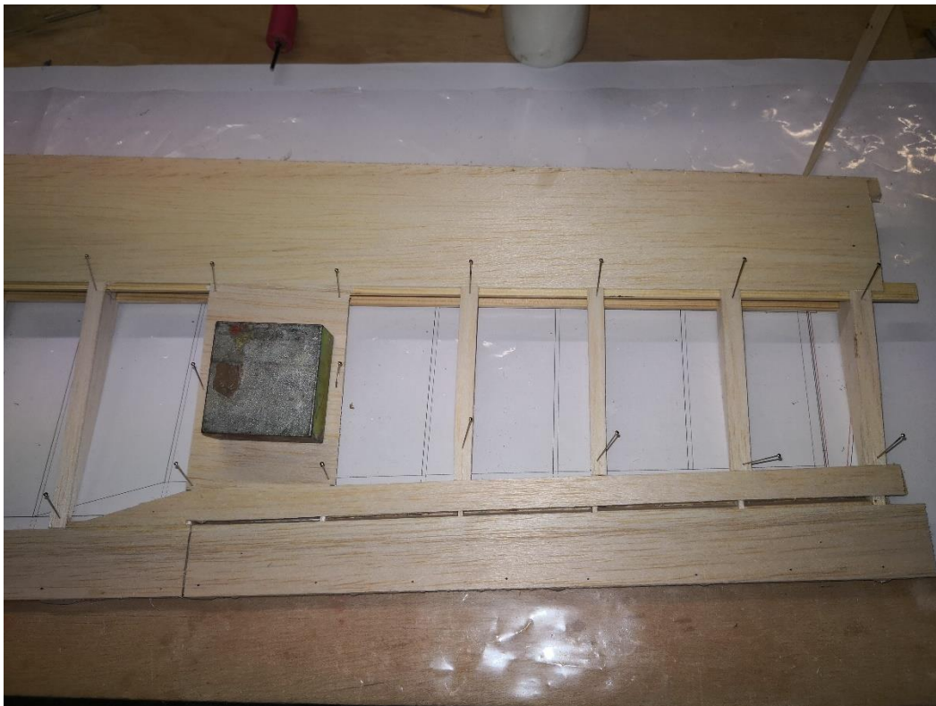
28: Die Aufleimer dienen später als Anlagefläche für die Kästen.
