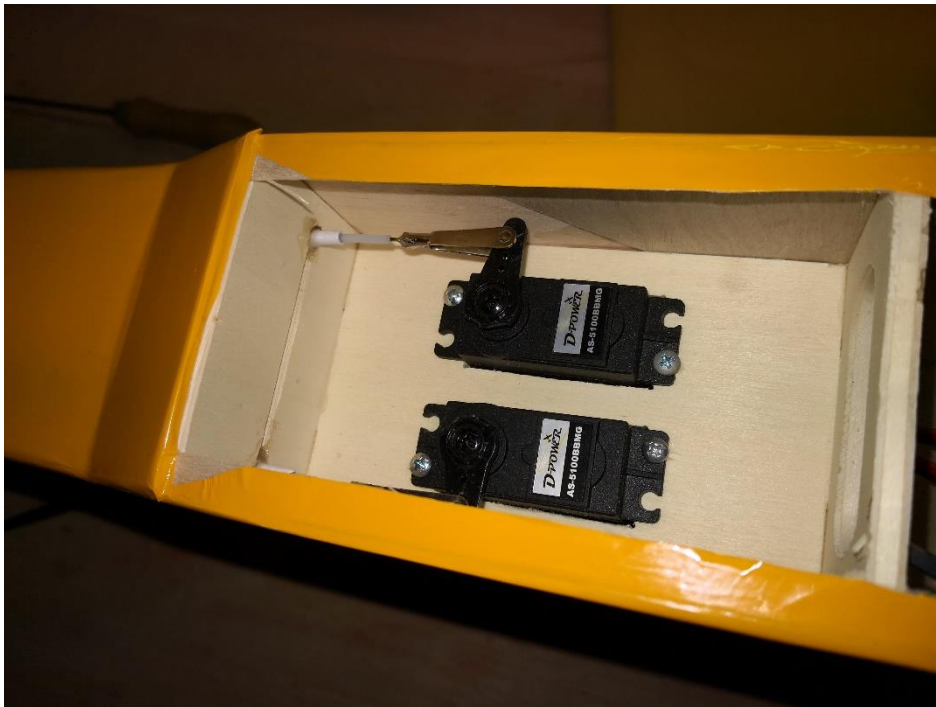
113: Servos verschrauben und Anlenkelemente verbinden. Bowdenzüge verkleben.
