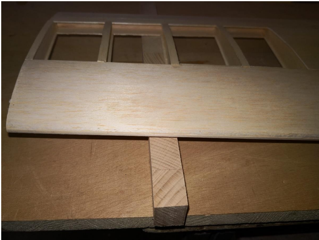
37: Beide Flügelteile auf dem Baubrett so anordnen, dass wie im Plan beschrieben die V-Form entsteht. Die Wurzelrippen ggfs. so plan schleifen, dass diese vollflächig zu verkleben sind.
