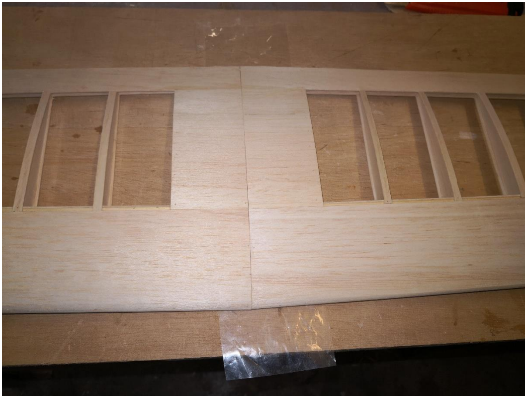
38: Die Klebestelle (Kaltleim) mit Folie unterlegen.
