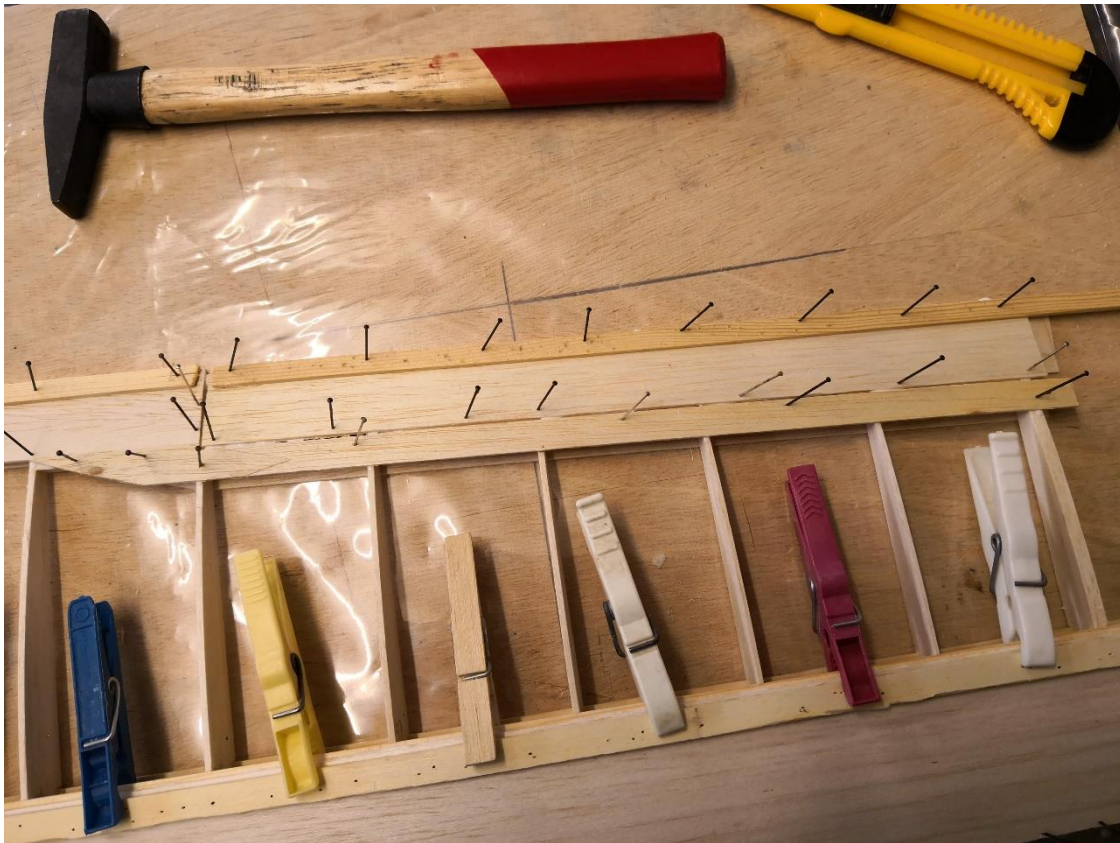
21: Endleiste mit Reststück Kiefernleiste auf den Tisch nageln. Beplankungsteile anstecken.
