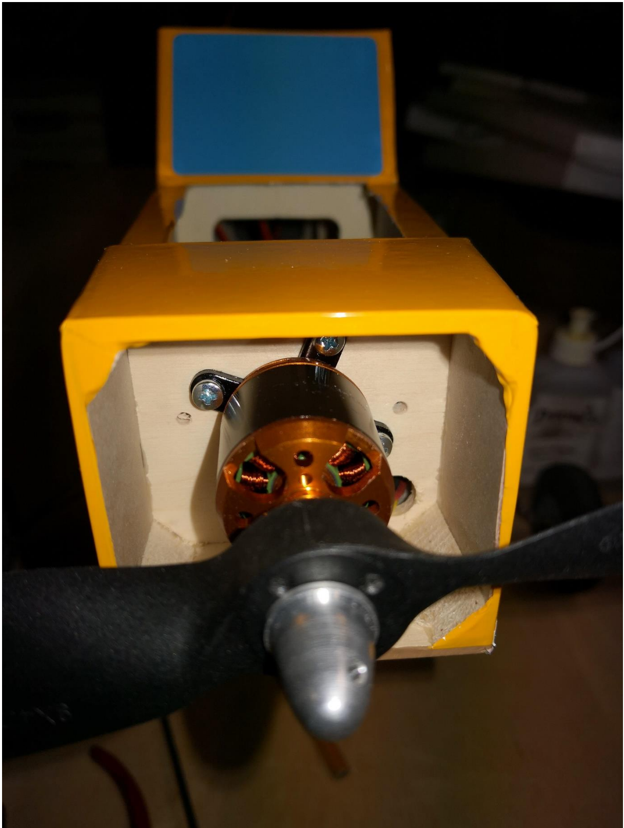
115: Der 28er Motor eim Einbauzustand. Zu erkennen ist auch das Bohrbild für den 35er.
