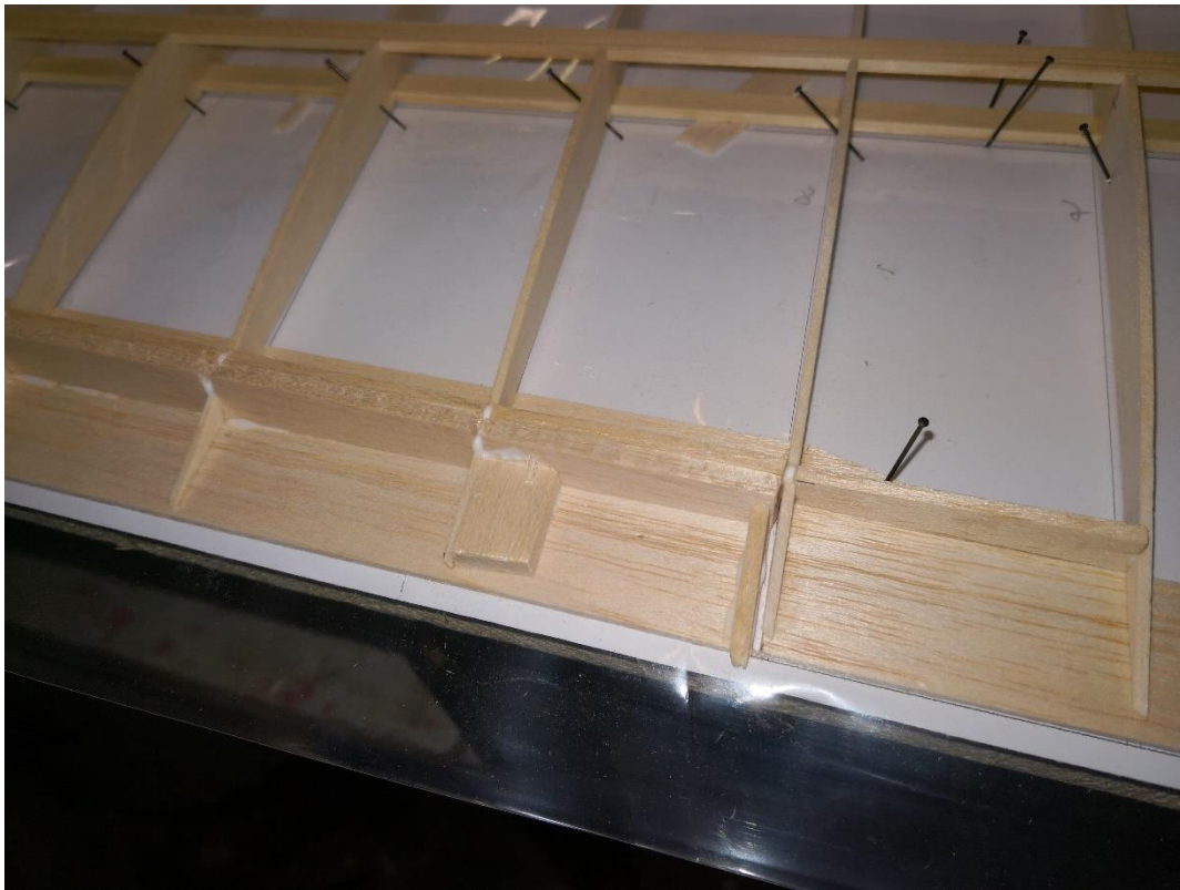
17: Auf der Querruderseite 6 mm Stege auf der Kreissäge schräg schneiden. Balsklotz für Ruderhorn vorsehen.
