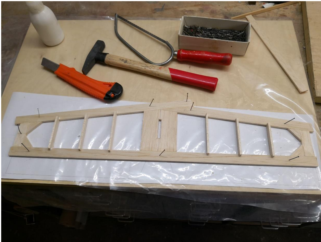
87: Jede Leiste wird abgelängt, eingeschnitten und dann auf dem Plan fixiert, bzw. mit dem angrenzenden Teil verleimt. Bei den Eckleimern auf die Richtung der Maserung achten. Rippen mit Überstand einsetzen.
