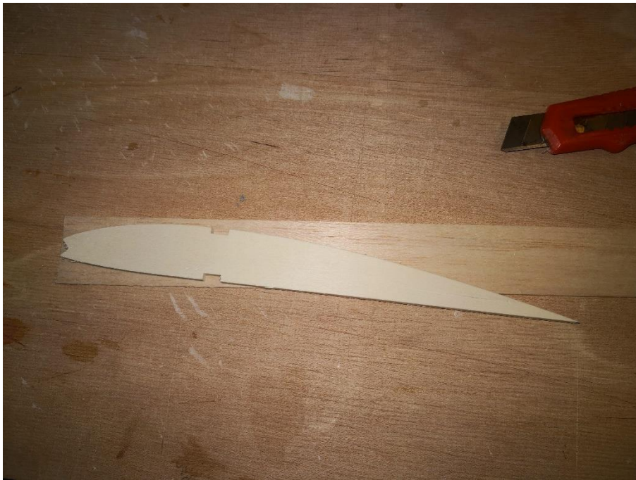
3: Die kleiner werdenden Rippen außen am Flügel kürzer zuschneiden
