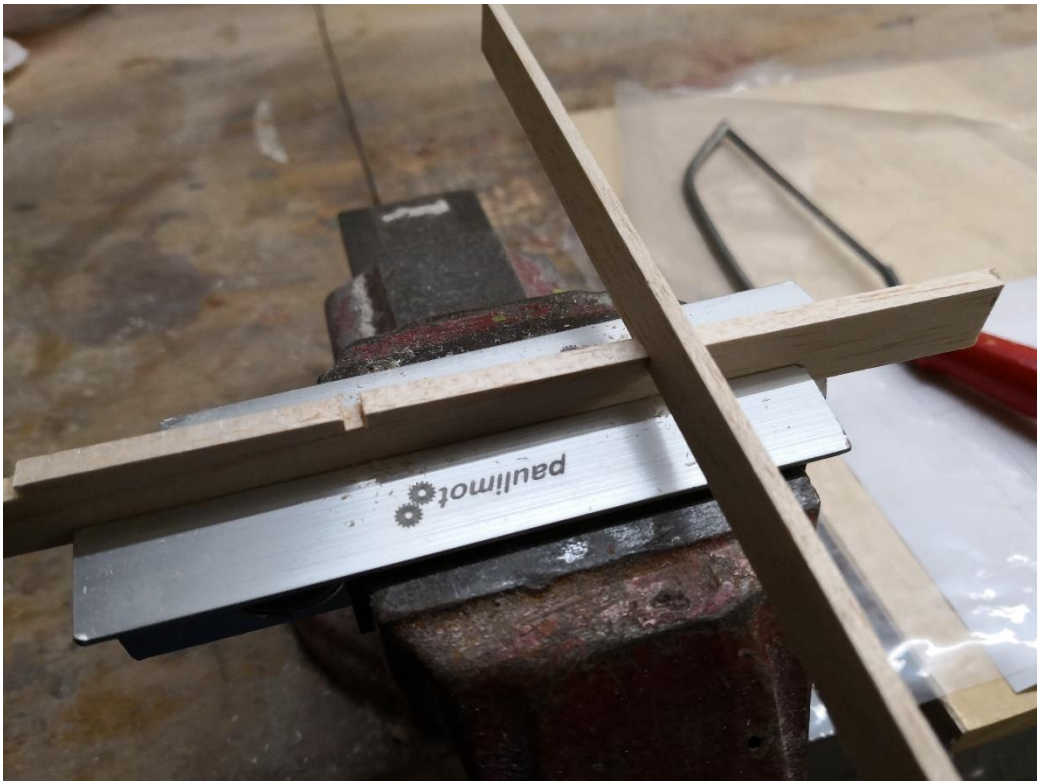
86: Sägen der Nuten für die Leitwerksrippen am Schraubstock. 3 mm Balsa zur Kontrolle des Abstandes.
