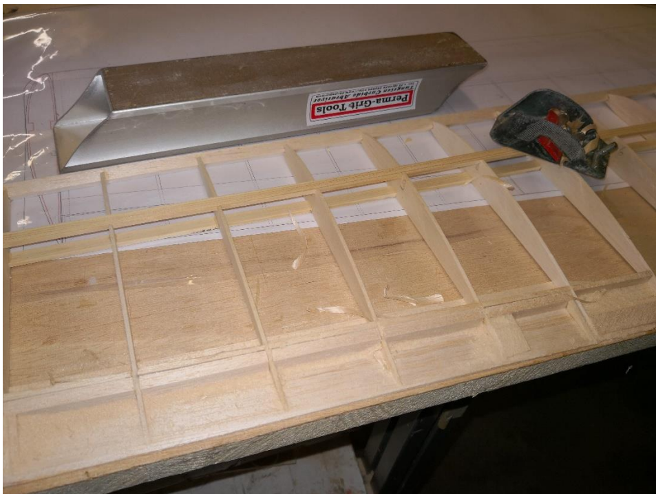
18: Endrippen QR-seitig einsetzen. Eckaussteifung am QR-Anfang und an Druckstücke (19) in Flügelmitte einkleben. Überstände hobeln und schleifen.
