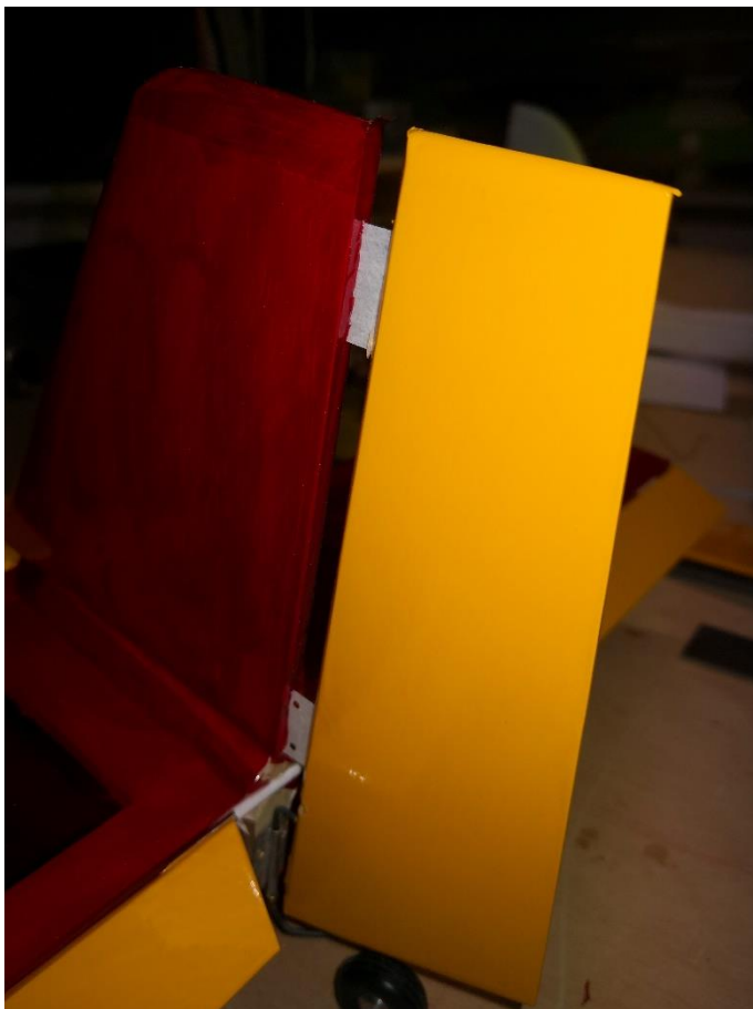
112: Seitenruder setzen, an HLW-Mitnehmer ausklinken.
