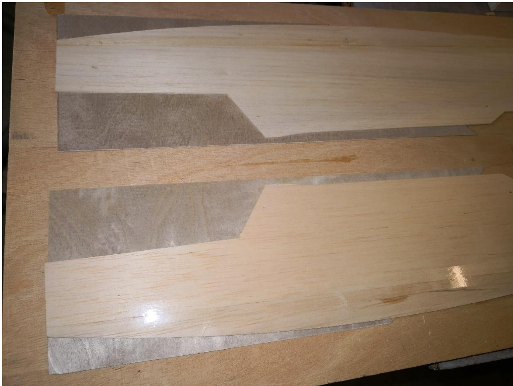
48: Rumpfseitenteile nach dem Pressen.
