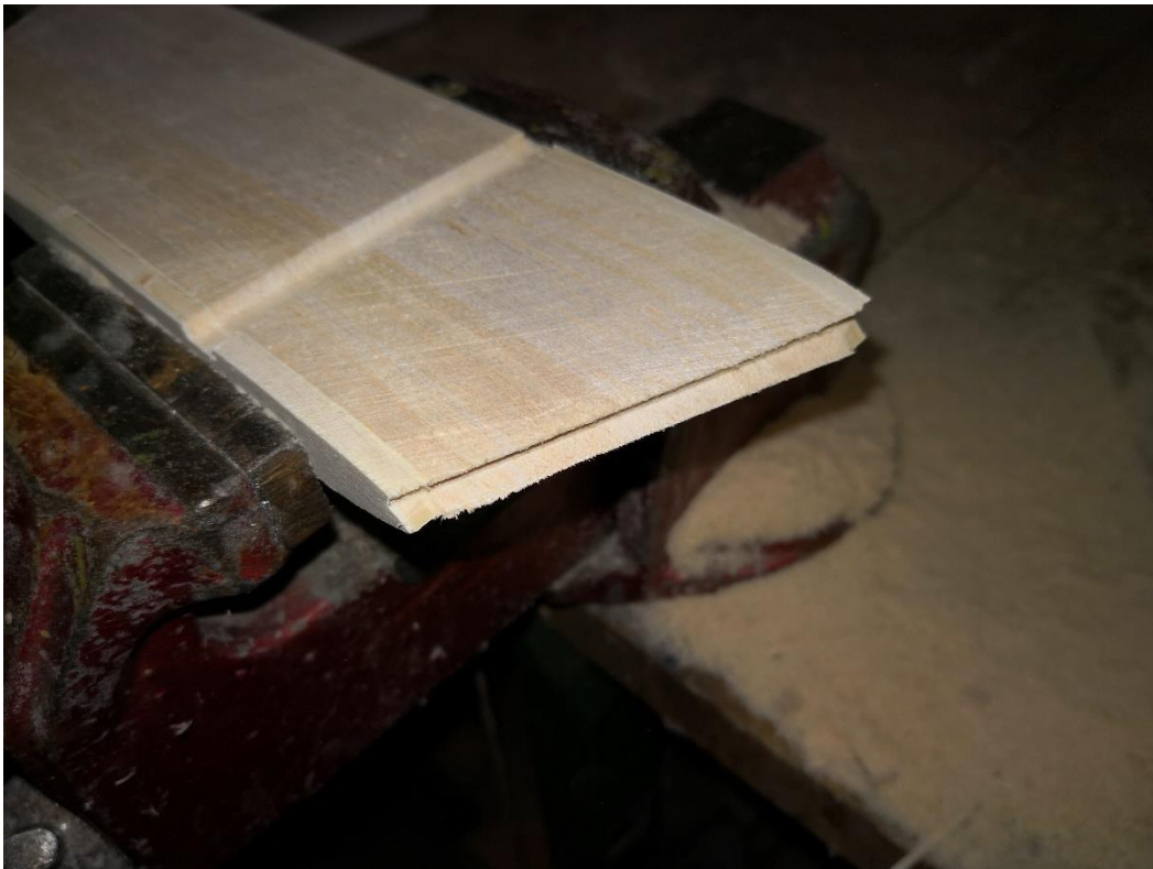
12: Auf der Unterseite gleich verfahren, abschließend den Ausschnitt für die Nasenleiste einsägen.
