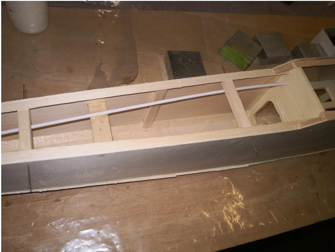
66: Um die obere Beplankung mit Maserung längs einbauen zu können, werden noch Abstandshalter (41) oben bündig eingeklebt.
