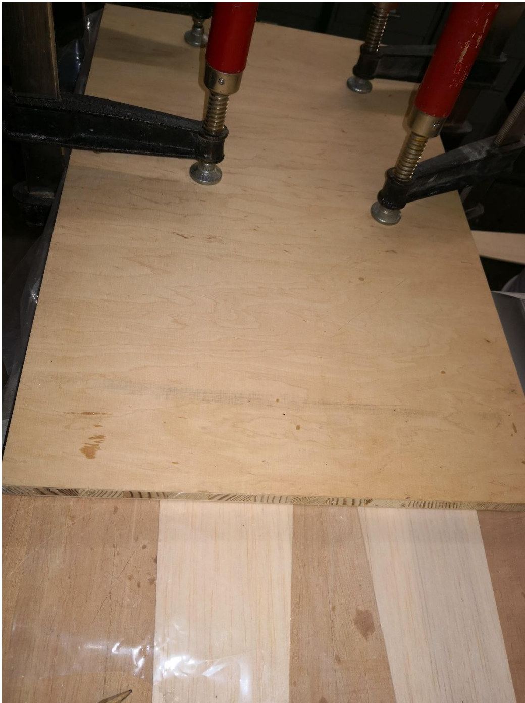
47: Balsa und Sperrholz zwischen zwei Baubretten mit Folie geschützt verpressen.
