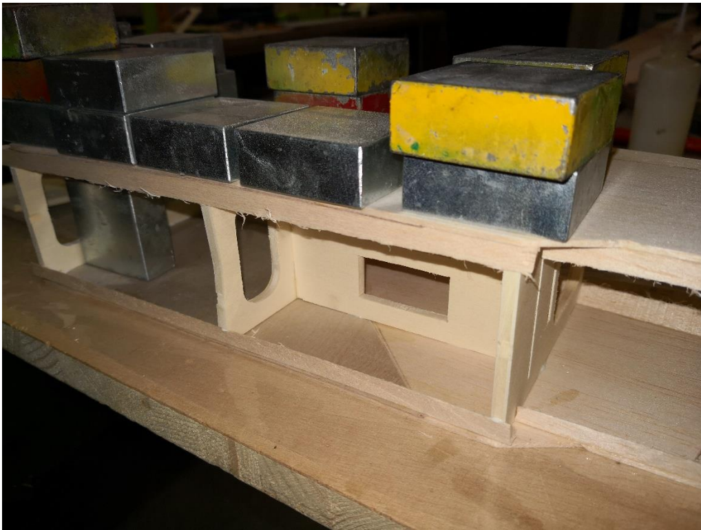
55: Der Rumpf wird über die mittleren Spanten verklebt. Dabei mit dem rechten Winkel die korrekte Lage kontrollieren.
