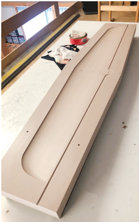
◀ ▶ Mit dem Formenbau – hier das Höhenleitwerk – hat RC-Flight-Academy schon Ende 2021 begonnen. Fotos: Erwin Schreiber
