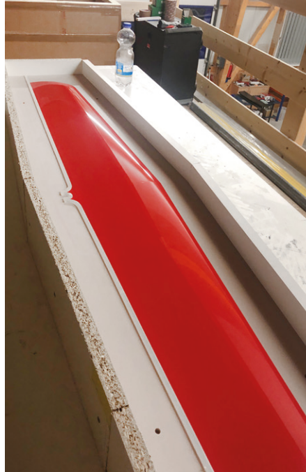
◀ ▶ Mit dem Formenbau – hier das Höhenleitwerk – hat RC-Flight-Academy schon Ende 2021 begonnen. Fotos: Erwin Schreiber
