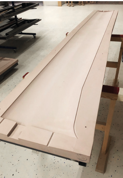
Links: Fräsform des Flächenmittelteils, rechts die Herstellung der Produktionsformen. Fotos: Erwin Schreiber.
