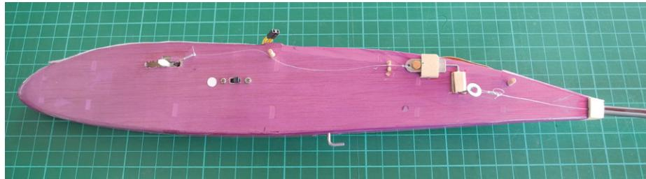
Der Auslösemechanismus für die Thermikbremse macht vielleicht einen eher rustikalen Eindruck. Ich wollte aber den Aufwand, alles in den Rumpf zu integrieren, vermeiden. Die Technik funktioniert einwandfrei und sehr zuverlässig ist sie auch.
