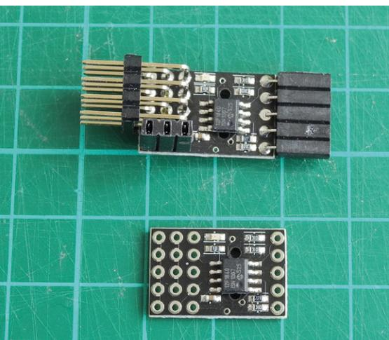
Das für den F1-Timer verwendete, mit SMD bestückte Prozessorboard mit einem PICAXE-08M2-Prozessor. Einmal im Lieferzustand und einmal mit den notwendigen Anschlussleisten.
