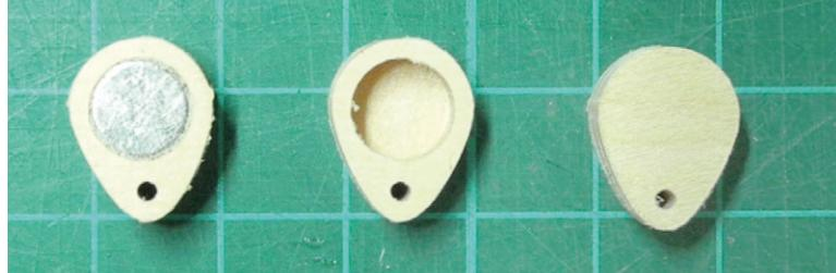
Meine gefrästen Magnethalter aus Holz sind durch Abschleifen fein in der Haltekraft einzustellen.
