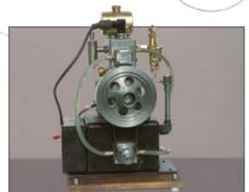
Viertaktmotor mit Einnockensteuerung
