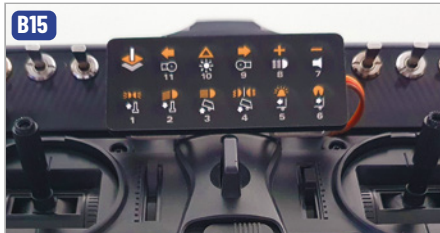
Steuerpad Licht und Sound mit Montagerahmen von Kraftwerk
