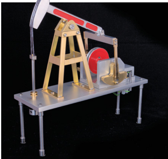
Modell einer Pferdekopfpumpe
