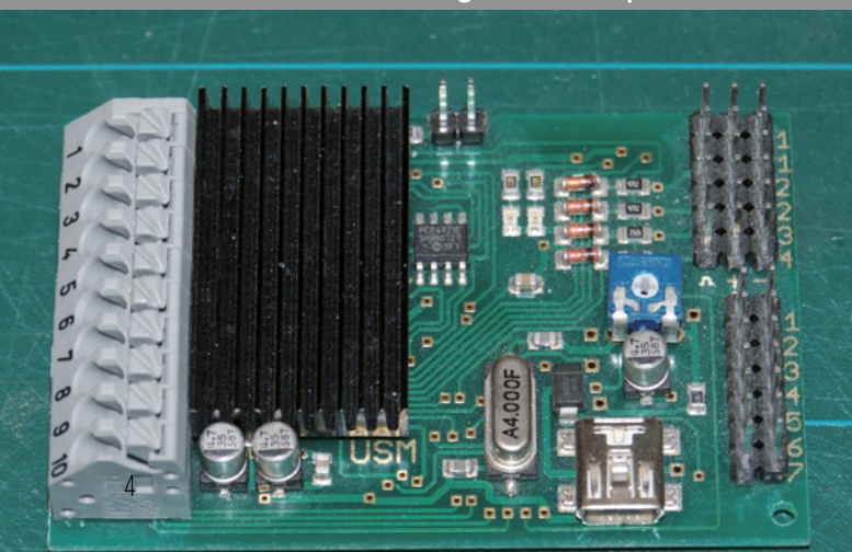
Das Soundmodul USM-RC bietet die Möglichkeit, im EKMFA-Modus nahezu alle Funktionen und Sounds über einen Fernsteuerungskanal anzusprechen.
