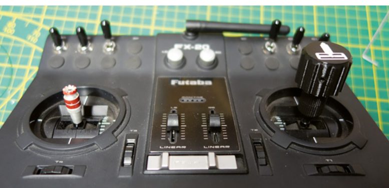
Um mit Drehregelknüppeln seine Schlepper fahren zu können, hat Christian Kamp Mithilfe von Harztec-Modellbau.de neue Drehregelsticks entworfen.
