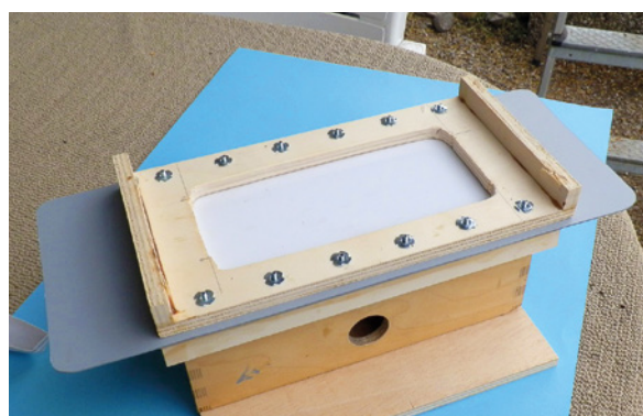
Jürgen Waldmann zeigt, wie man eine Tiefziehvorrichtung selbst bauen kann.
