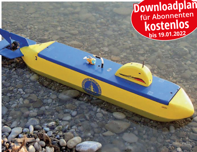
Das Modell-U-Boot Spook entsteht komplett aus Holz und kann dynamisch tauchen.
