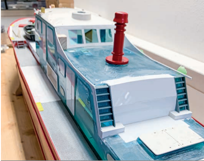
Martin Ebers Umbau der Düsseldorf zum aktuellen Feuerlöschboot Hydra der Kölner Feuerwehr schreitet voran. In Teil 3 geht es nun um die Veränderung der Aufbauten.
