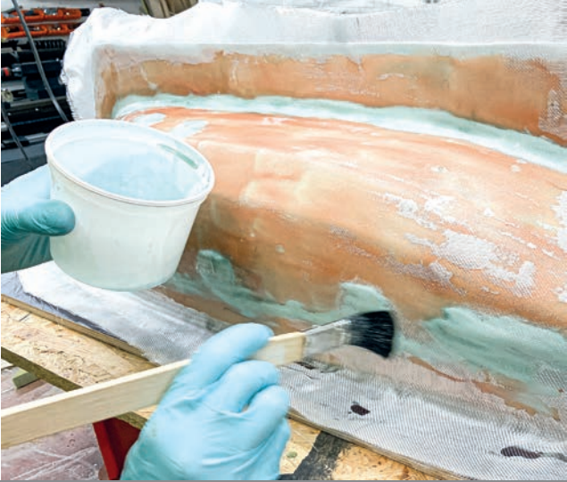
GFK-Rümpfe einfach selbst laminieren? Eine Negativ-Form macht's möglich. Günter Schmedeshagen erklärt, wie solch eine Form erstellt wird.
