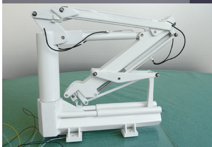
Funktionsfähiger Ladekran aus dem 3D-Drucker
